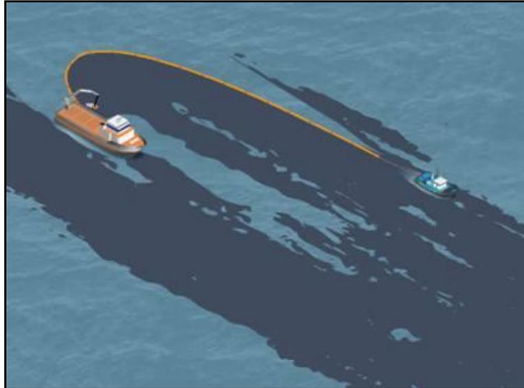
Figura 79. Formação "J" com uma das embarcações recolhendo o óleo contido.
