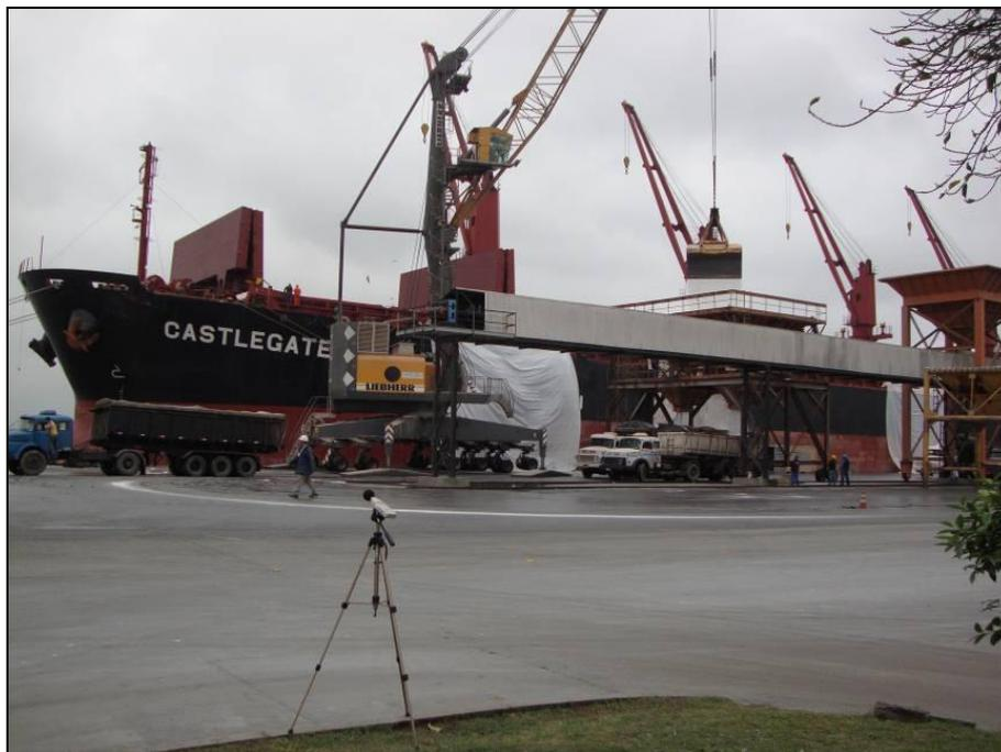
Figura 7. Operação de descarga de fertilizante no Cais Público onde é utilizado guindaste, funil e caminhões.
