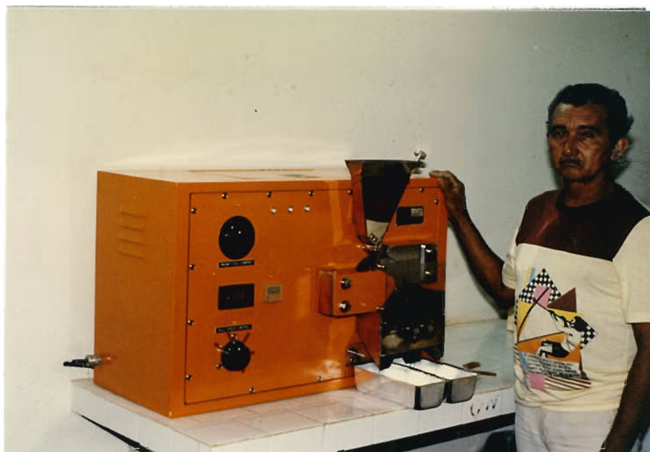
Separador Magnético CARPCO - Modelo MLH 13-111-5 série 157/84 Neste separador o material cai diretamente sobre o cilindro montado. A separação não é tida como satisfatória.
