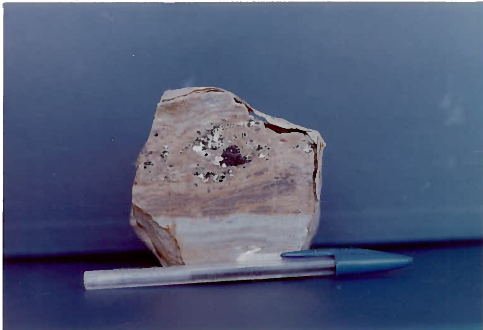
Foto 02:- Amostra de metassedimento carbonático, mostrando o nítido processo de substituição seletiva da fluorita, relacionada às bandas carbonáticas.
