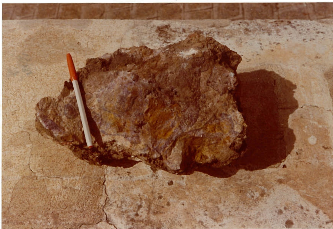
Brecha polifásica da trincheira T 4 . É constituída por fragmentos de microbrecha, cimentados por fluorita, barita e sílica.
