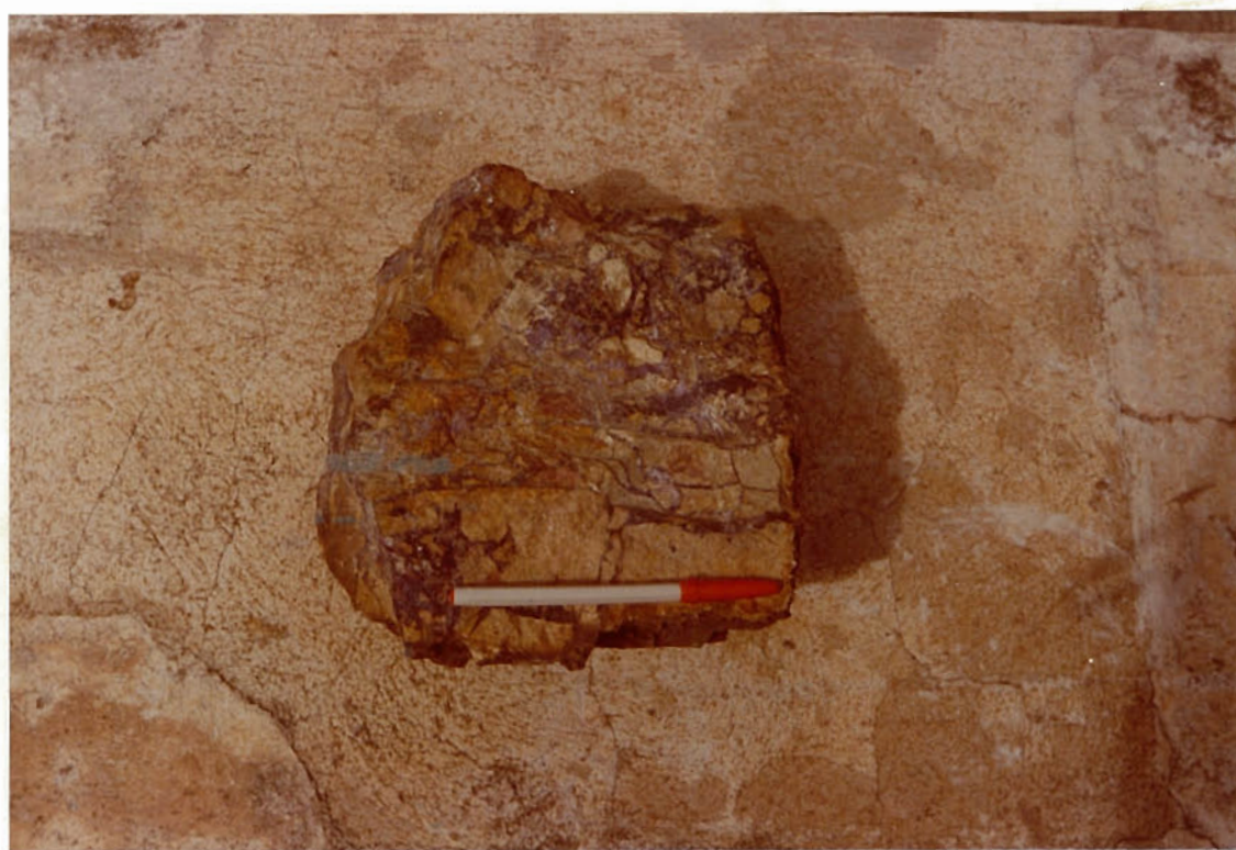
Brecha polifásica da trincheira T 4 . É constituída por fragmentos de microbrecha, cimentados por fluorita, barita e sílica.
