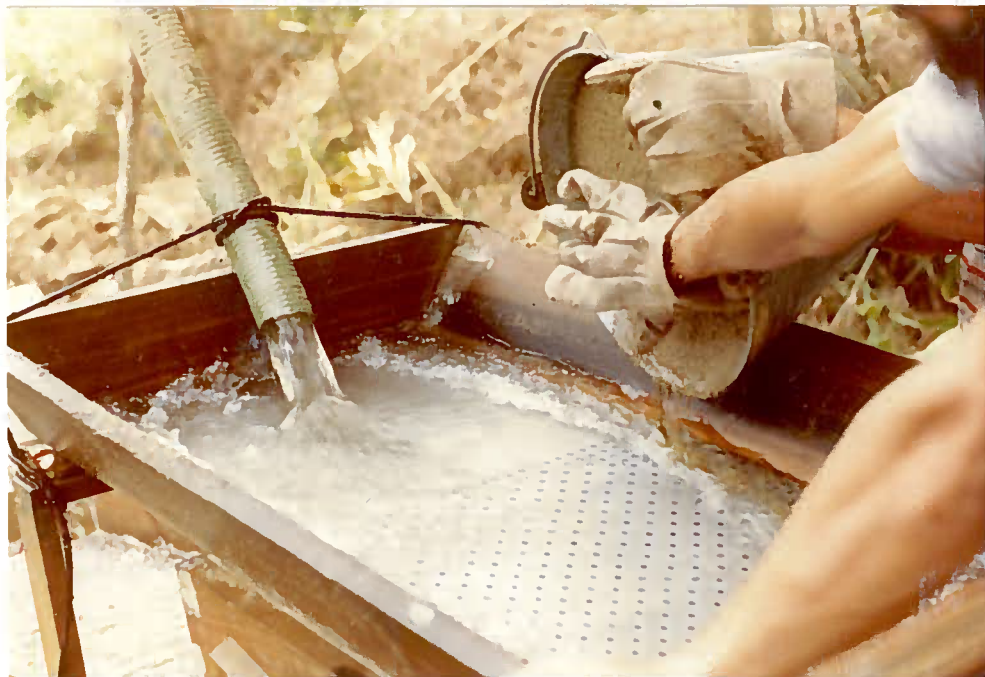
Foto 04 - Pré-concentração. Colocação do material sobre a "Lavadeira" para desagregação. O fundo da caixa é uma placa de aço com crivos de 6 mm.
