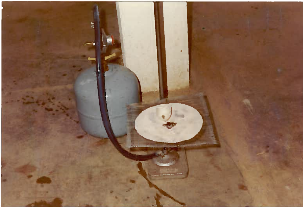
Foto 18 - O mercúrio é evaporado, liberando o ouro. Normalmente é colocado um papel de filtro umedecido sobre o cadinho para recuperar o mercúrio que se condensa sobre este.
