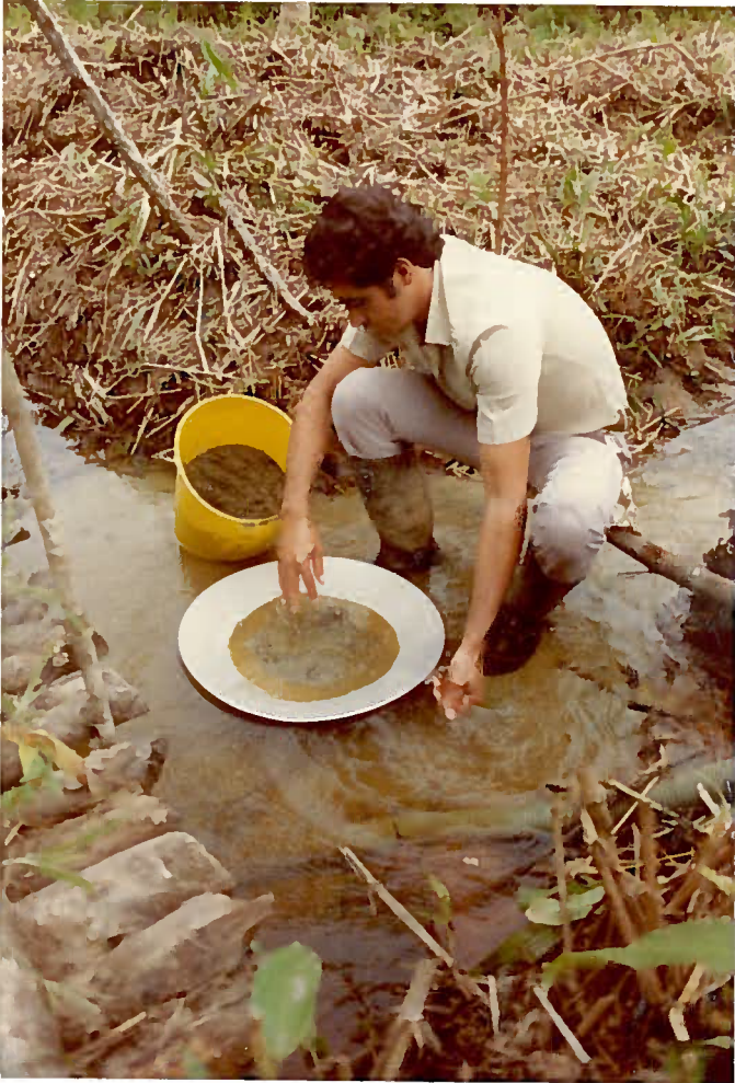
Foto 11 - Preparação do concentra- do de minerais pesados. Início de trabalho: o material é passado, por partes, do balde para a bateia.
