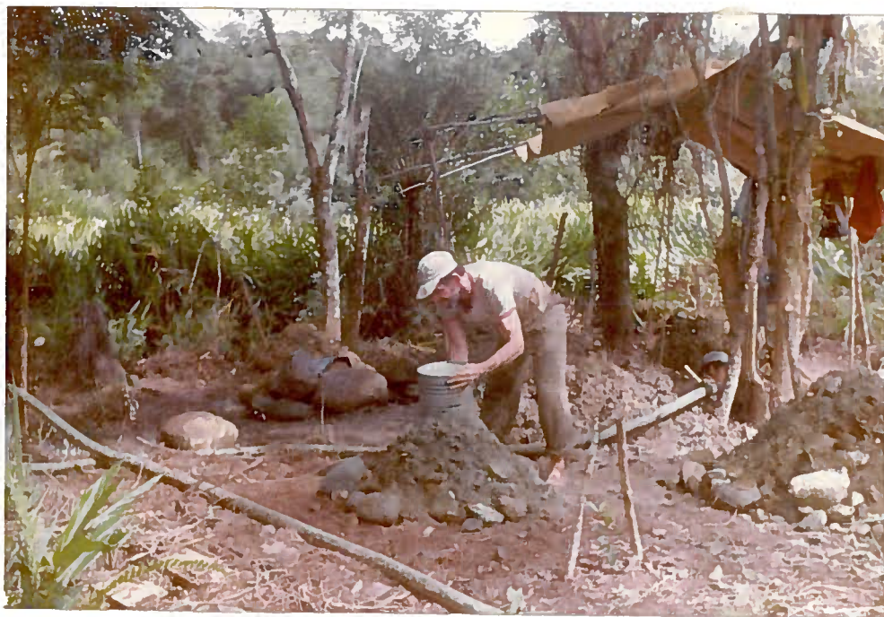
Foto 02 - O material é amontoado a intervalos de 0,50 \text{ m}^3 , ao redor da boca dos poços. A seta aponta para uma estaca cravada no monte contendo a identificação do intervalo amostrado.
