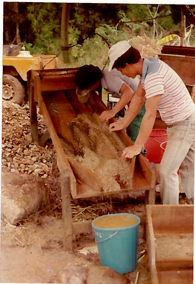
Foto 09 - Lavagem da cobra fumando e recuperação do pré-concentrado no balde plástico.
