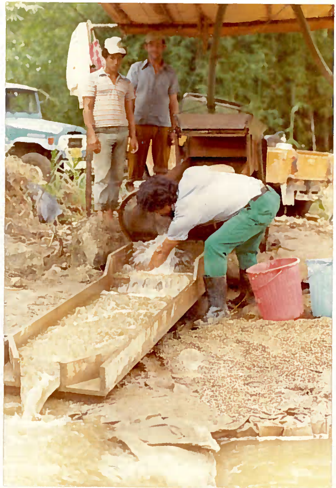
Foto 06 - Equipamento de pré-concentra- ção operando. A peneira colocada sobre o "sluice" auxiliar é descarregada. Na base do poço, os tanques de decantação.
