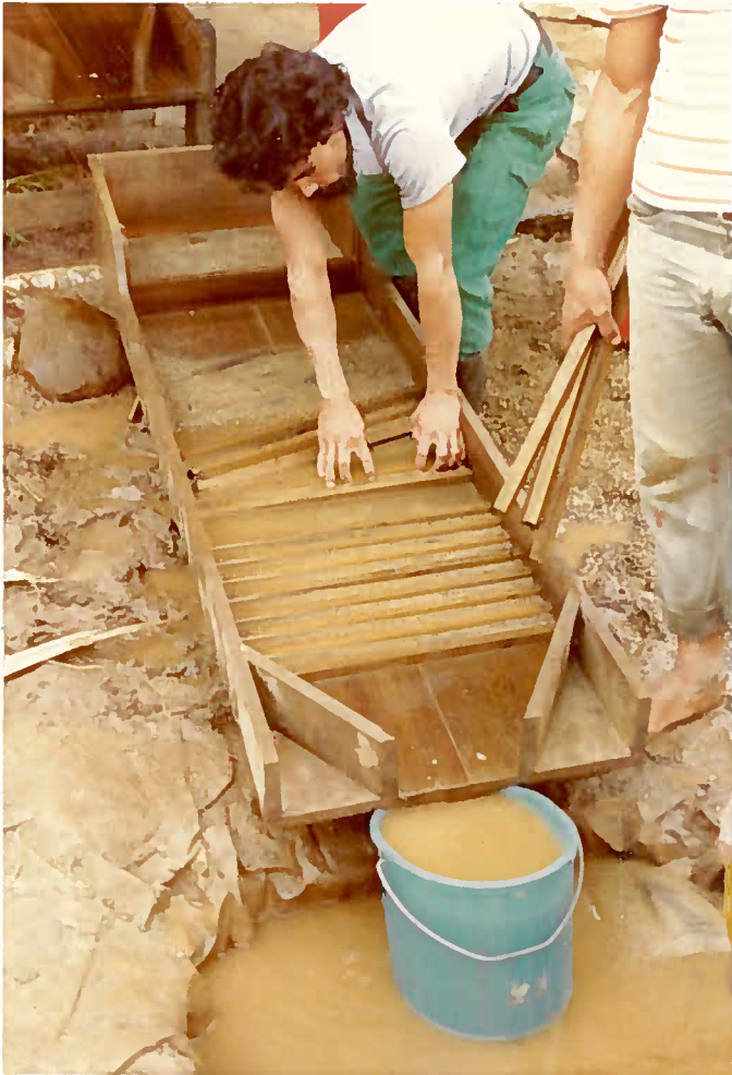
Foto 07 - Desmontagem do "sluice" para recuperação do pré-concentrado de minerais pesados.
