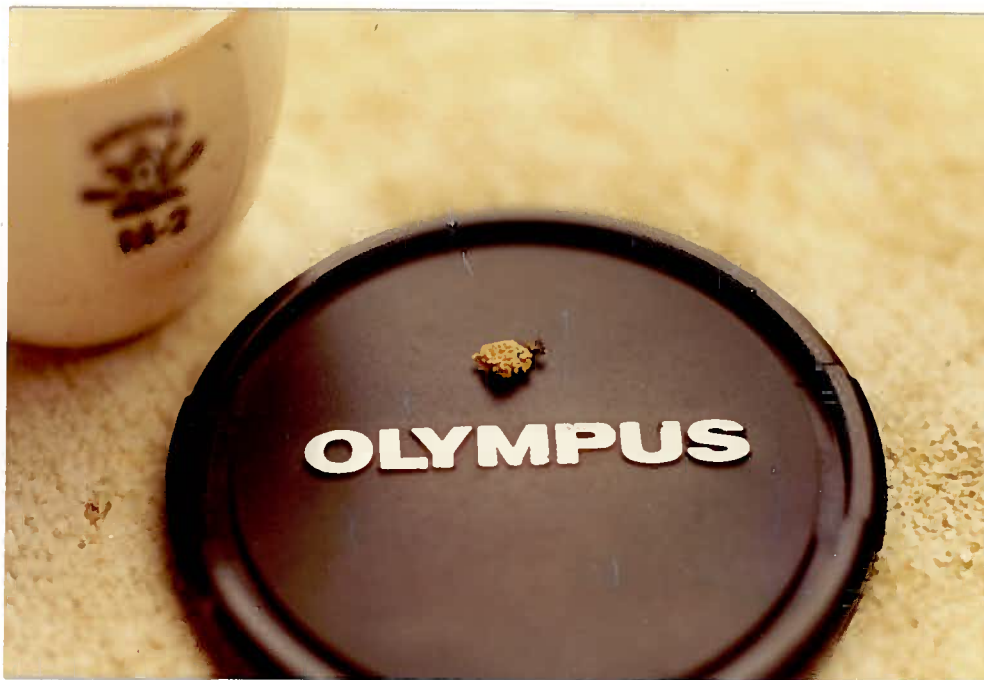
Foto 19 - O ouro recuperado pela amalgamação. As pequenas partículas ficam unidas formando um aglomerado de ouro.
