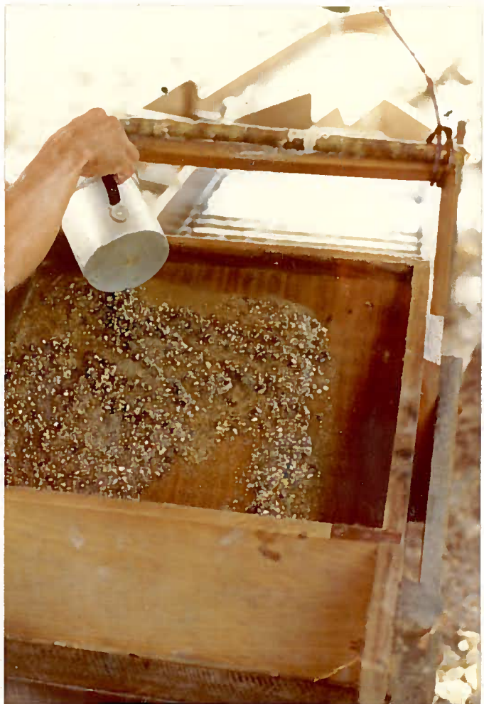
Foto 08 - Lavagem dos "sluices" após a desmontagem, o equipamento é lavado com água limpa para a recuperação do pré-concentrado. Na foto, lavagem do "para-quedas" já sem rifles.
