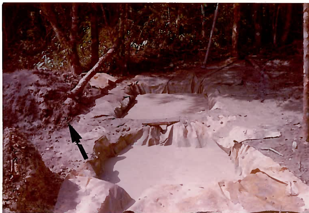
Foto 22 - Controle de Qualidade - O rejeito do equipamento de pré-concentração no estado de polpa era homogeneizado nos tanques de decantação. A seta aponta o material pronto para amostragem.
