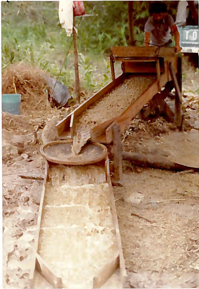
Foto 05 - Pré-concentração cobra-fu- mando e "sluice" auxiliar em ope- ra- ção.
