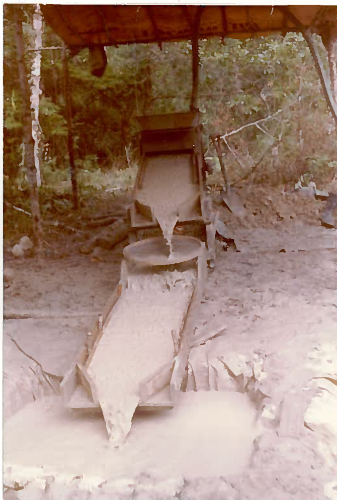
Foto 21 - Controle de qualidade. O rejeito da "cobra fumando" é armazenado em tanque de decantação forrado de plástico, evitando a contaminação da amostra.
