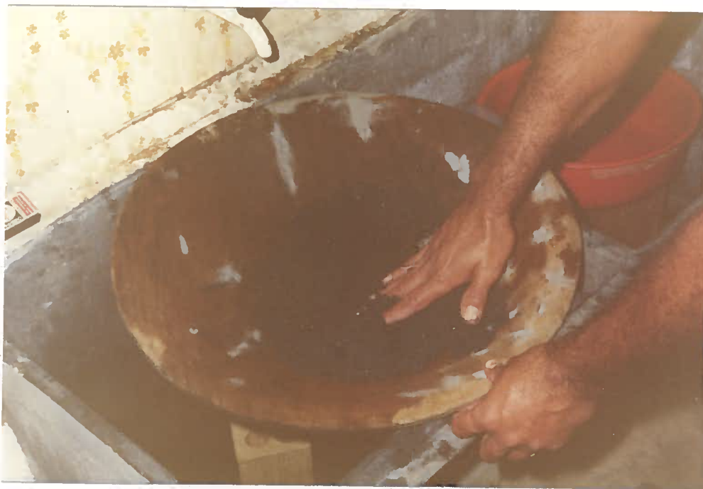
Foto 13 - Amalgamação. O mercúrio é misturado ao concentrado de minerais pesados até a completa homogeneização.
