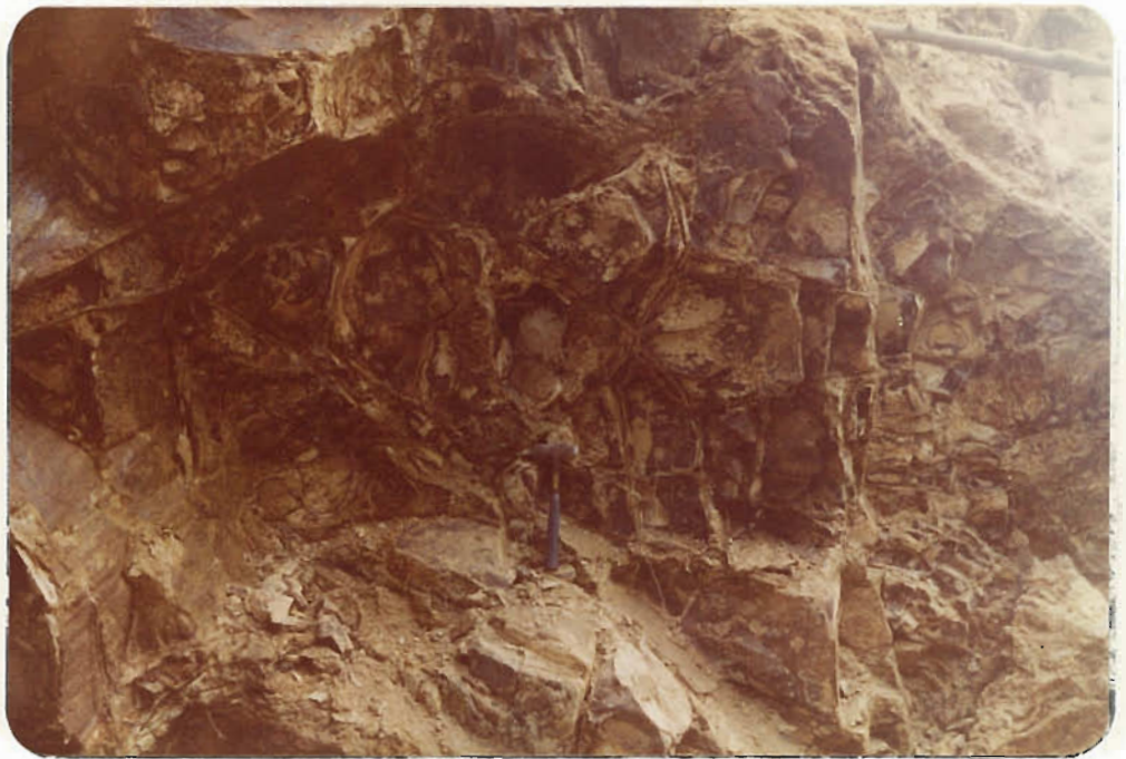
Foto 9 - Fraturamento em dique de diabásio. Pt RA 23.
