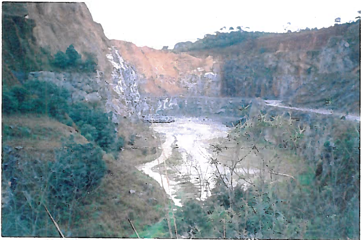
Foto 04: Vista panorâmica da pedreira da Andraus, com o sistema de banquetas e uma espessa camada de estéril.
