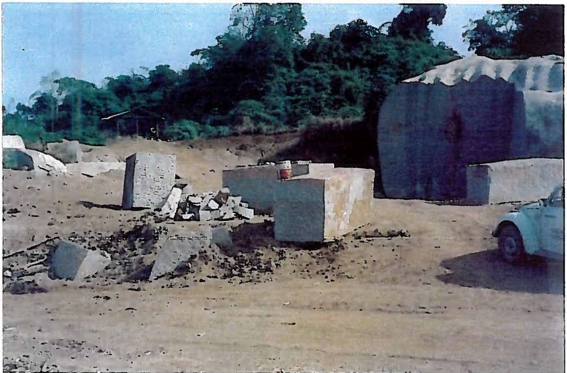
Foto 10: Detalhe do corte em matacões de granito para a retirada e blocos para posterior beneficiamento, próximos a Três Córregos.
