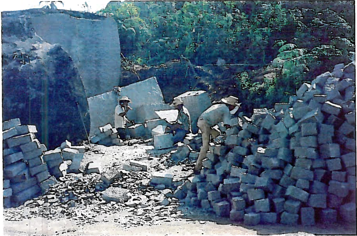
Foto 11: Detalhe de trabalhadores desdobrando blocos de granito em paralelepípedos.
