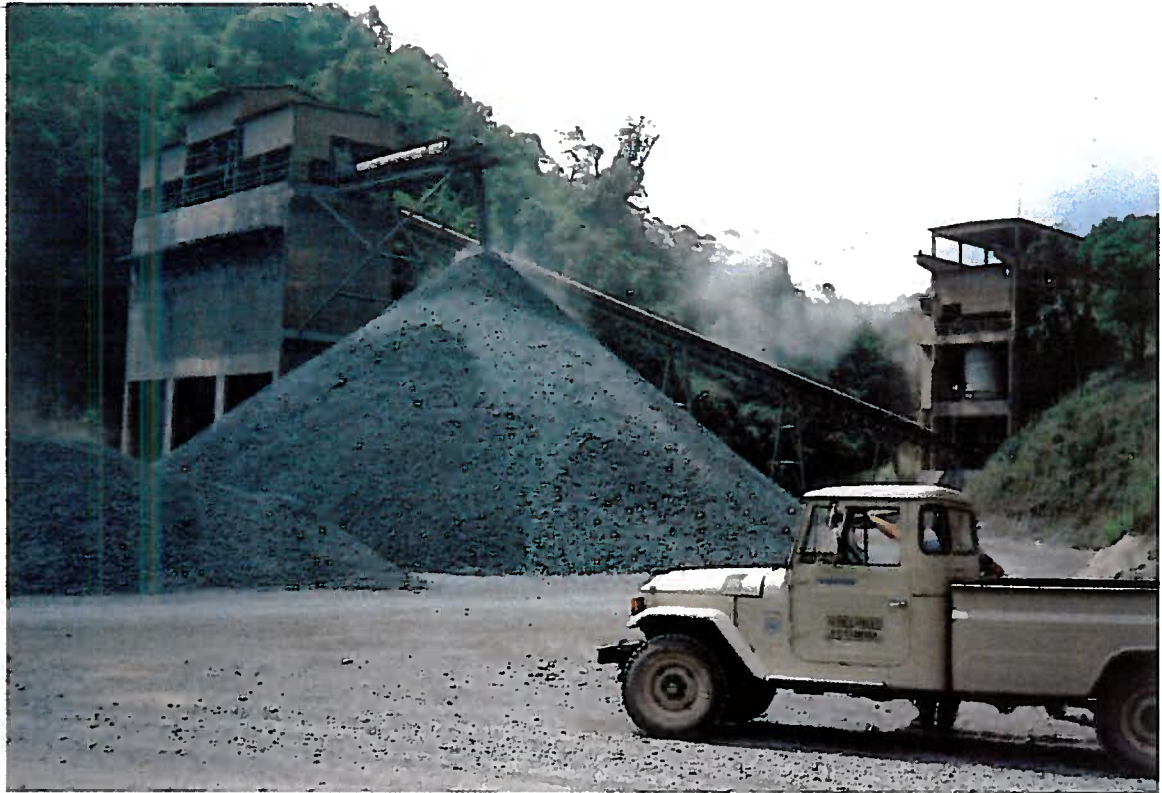
Foto 03: Detalhe do beneficiamento (britagem) do calcário na jazida da Cia de Cimento Itambê, para transporte até a fábrica.
