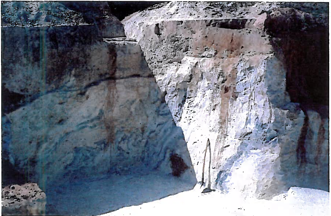
Foto 06: Detalhe da foto anterior, onde podemos observar o bandeamento do caulim e o trabalho de separação do mesmo.
