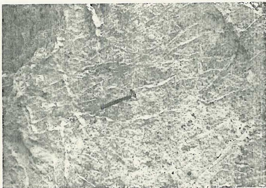
FOTO 12.2 - Juntas do tipo  $J_3$  e feldspato alterado
