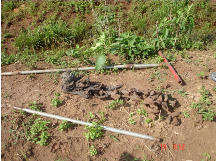
Foto 37 – Vista do trado manual utilizado na coleta de argila..
