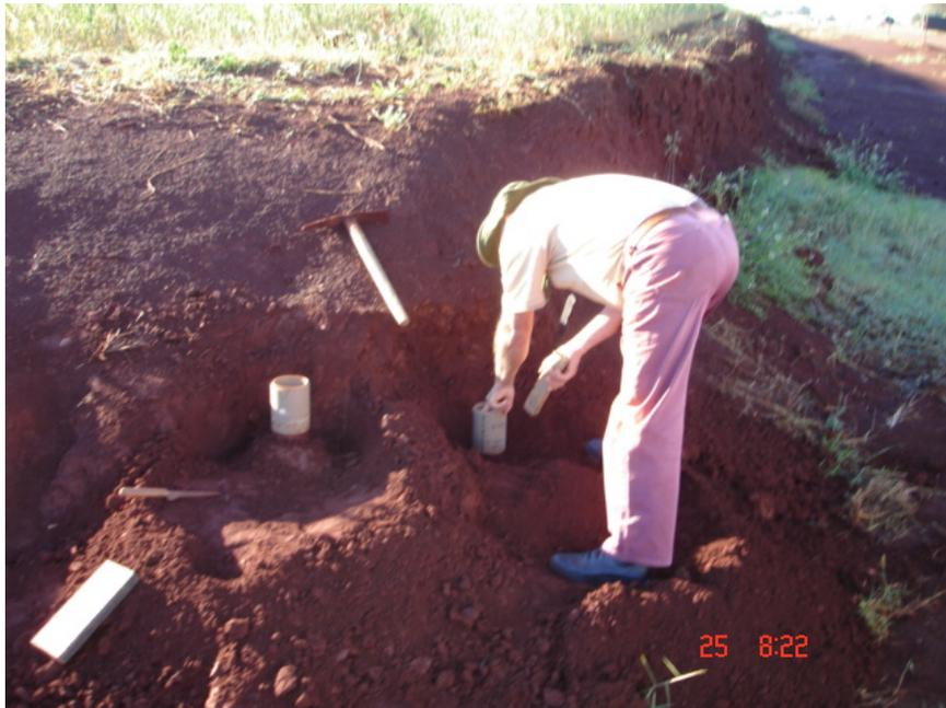
Foto 36 – Vista da coleta de amostras indeformadas para ensaios geotécnicos.
