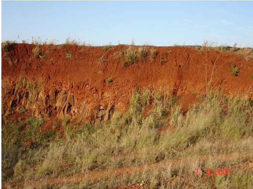
Foto 31 – Perfil típico do solo da região. (solo residual maduro, solo litólico, rocha alterada e rocha fresca)
