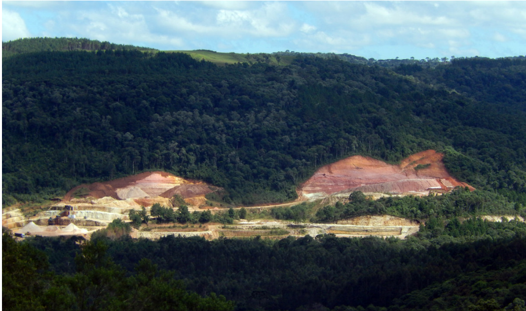
Foto 5: Lavra de arenito nas margens da rodovia entre União da Vitória e Cruz Machado. A parte basal, em tom creme esverdeado, é de um arenito do topo da Formação Rio do Rastro. Sem uso na construção civil. Estação de Campo LL-1152.
