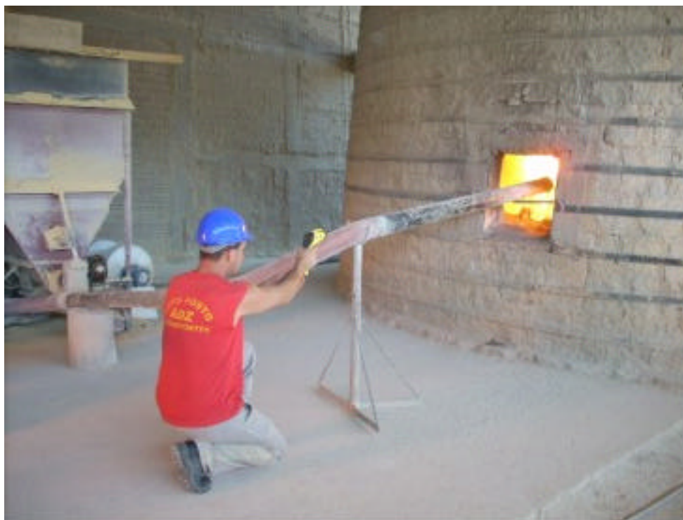
Figura 03 – Máquina de serragem e sistema de injeção nos fornos.
