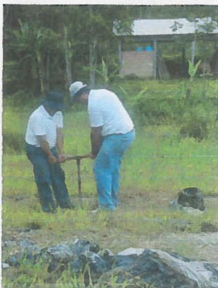
Foto 2: Execução do furo a trado para coleta de amostra.
