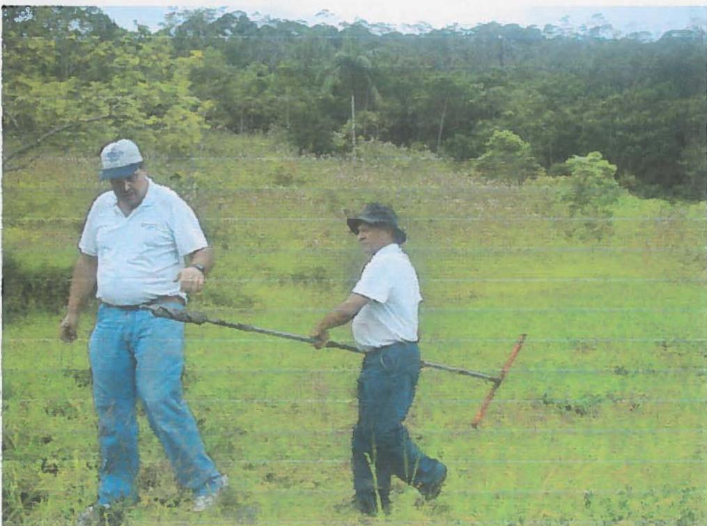
Foto 3: Retirada da haste do trado para a coleta da argila.
