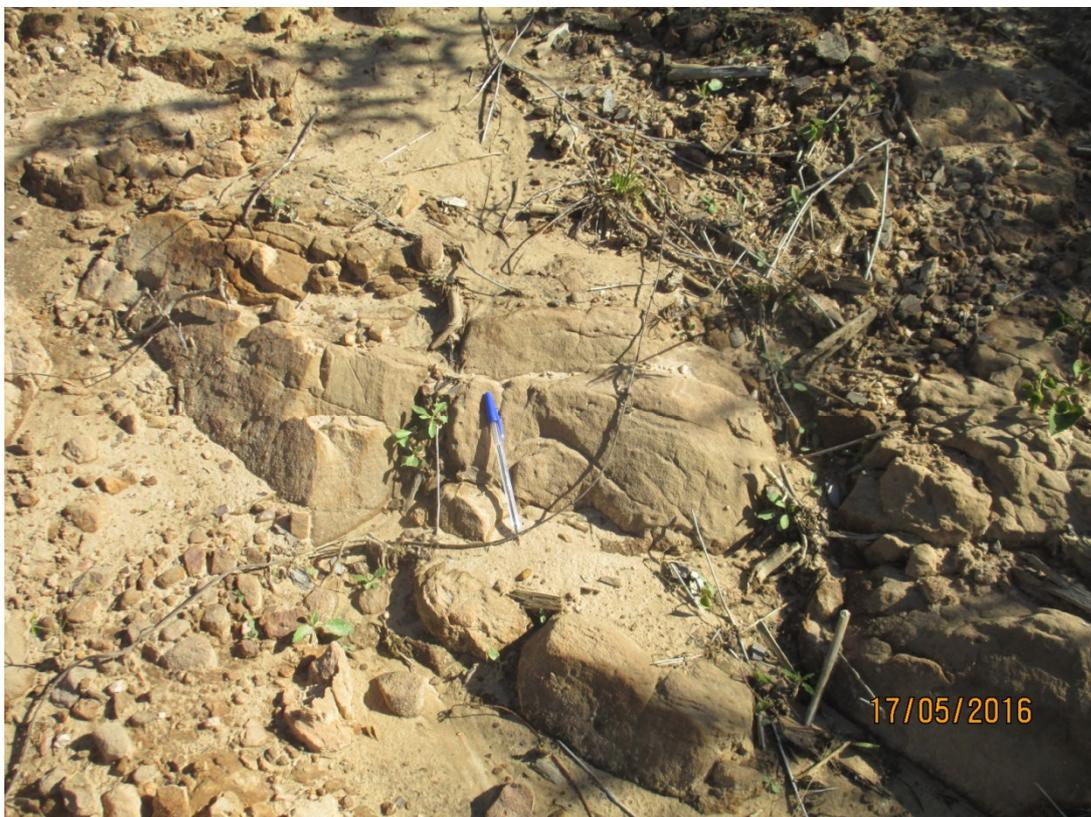
Foto 1: Afloramento de arenito claro, estratificado e fino. Estação de Campo AC-1600.
