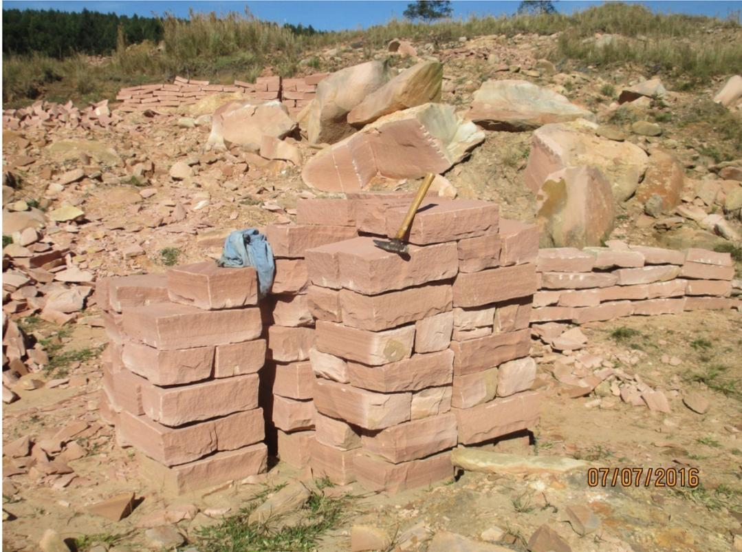
Foto 27: Lavra e produção de paralelepípedos de arenito silicificado Estação de Campo AC-1691.
