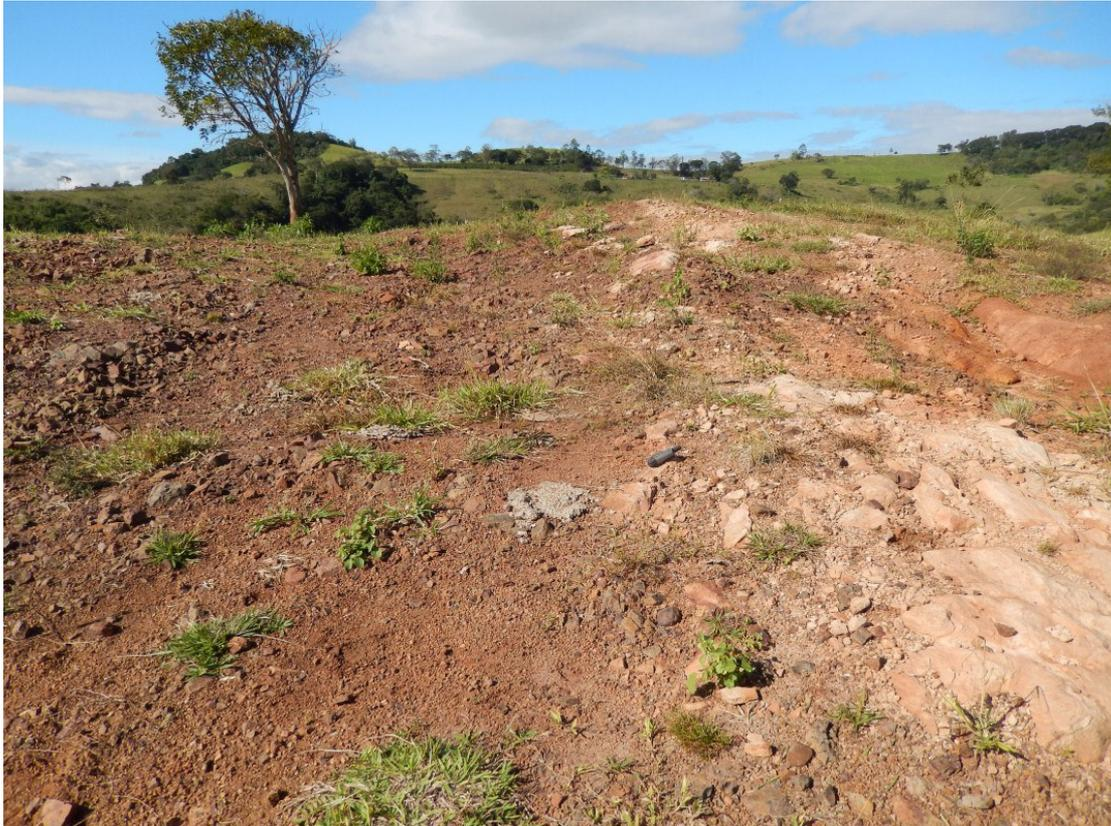
Foto 21: Arenito resistente, fino à direita da foto e, em contato com o basalto, à esquerda da foto. Não há evidência de diferença de morfologia ao se avaliar a superfície do terreno. Estação de Campo AG-036.
