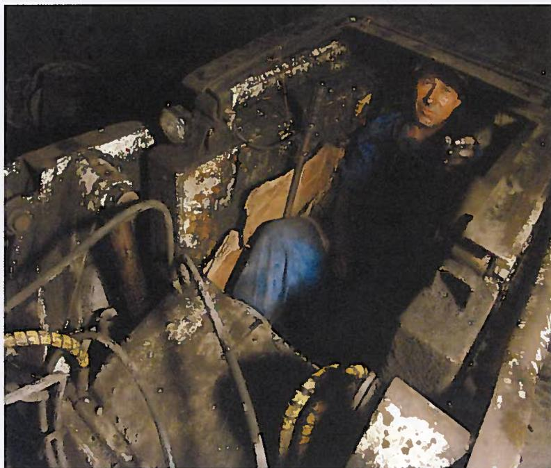
*Acima: como a mina de Figueira é explotada na altura das camadas de carvão, todo o equipamento é dimensionado para atuar neste horizonte, de cerca de 1,60m de altura. Carregadeiras preparadas condicionam os operadores a trabalhar praticamente deitados. Ao lado: no processamento, o carvão selecionado, britado e classificado é transportado por esteiras.*
