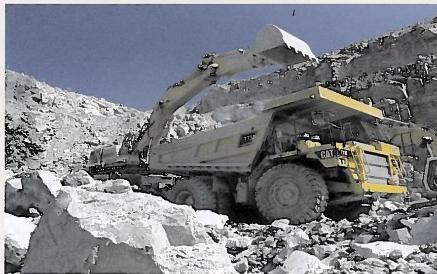
*Foto maior: afloramento de siltito/argilito na região de Prudentópolis, de onde se extrai o barro para tijolos e telhas. Cerâmica Gnatta. Acima: extração de calcário calcítico para fabricação de cimento da empresa Votorantim em Rio Branco do Sul.*
