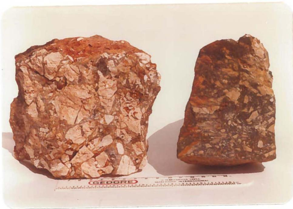
Foto nº 15 - Brecha com fragmentos de granito cimentados por sílica. (Pt nº SR-194).
