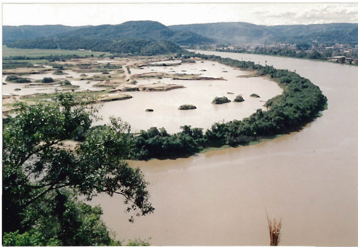
Foto 01 - Panorâmica na atividade de extração de areia em cava submersa, situada na planície de inundação do rio Iguaçu, próxima a zona urbana da cidade de União da Vitória.
