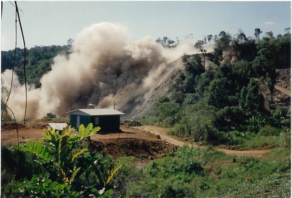
Foto 08 - Pedreira de basalto para produção de pedra-brita e pedra de cantaria. Detalhe da explosão para o desmonte primário da rocha.
