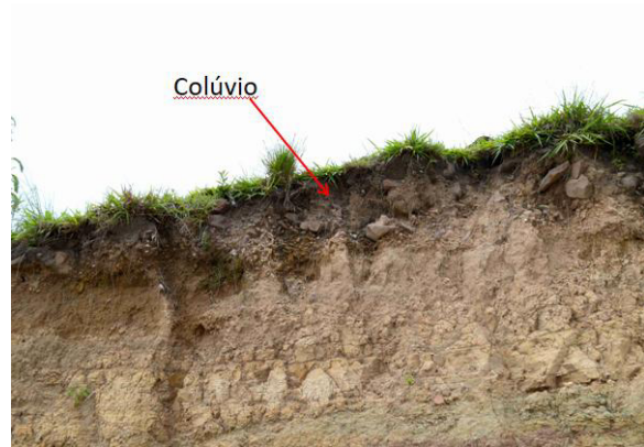
Imagem 17 – Colúvio fino a grosso de blocos de basalto e arenitos sobre arenitos finos da Formação Rio do Rastro. Ponto PD-33 - Unidade Residual Serra Geral.
