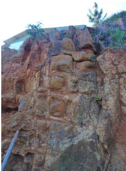
Imagem 6 – Alteração típica de rochas basálticas, início de alteração esferoidal.
