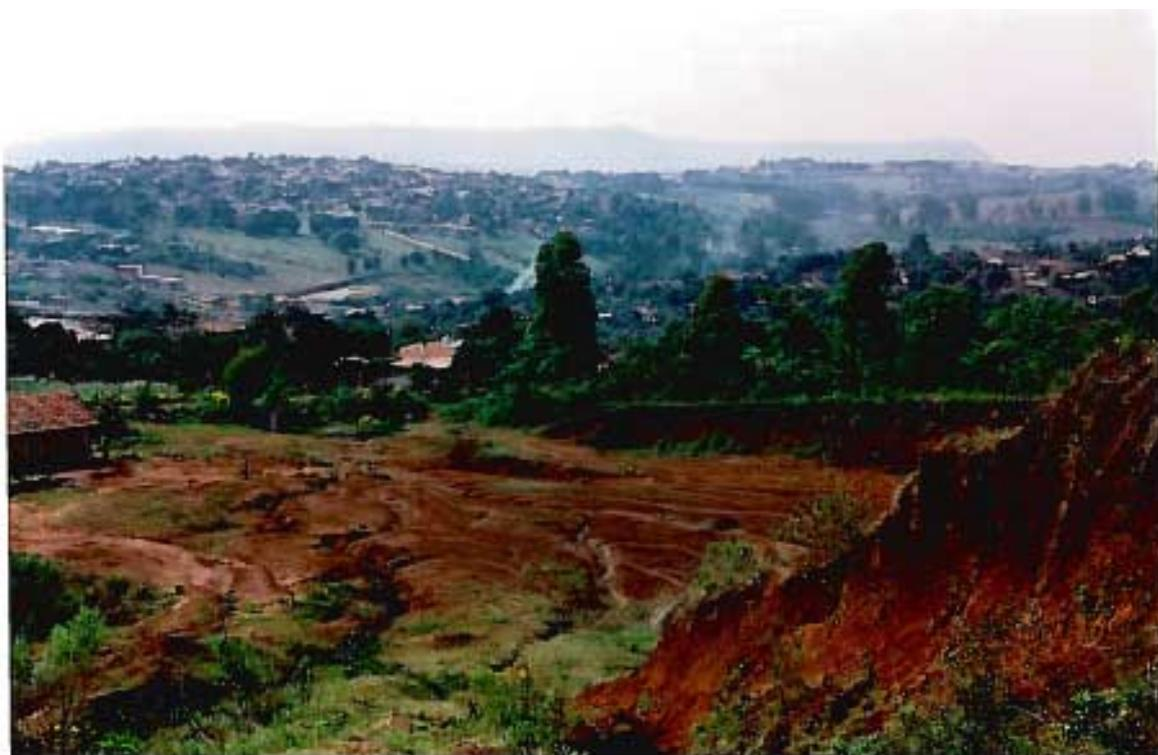
Foto 9 - Aspecto de depósito coluvionar em área de muito alta declividade, sujeita a processos de escorregamento de massa, erosão e rolamento de blocos, no sopé do Morro da Antena.
