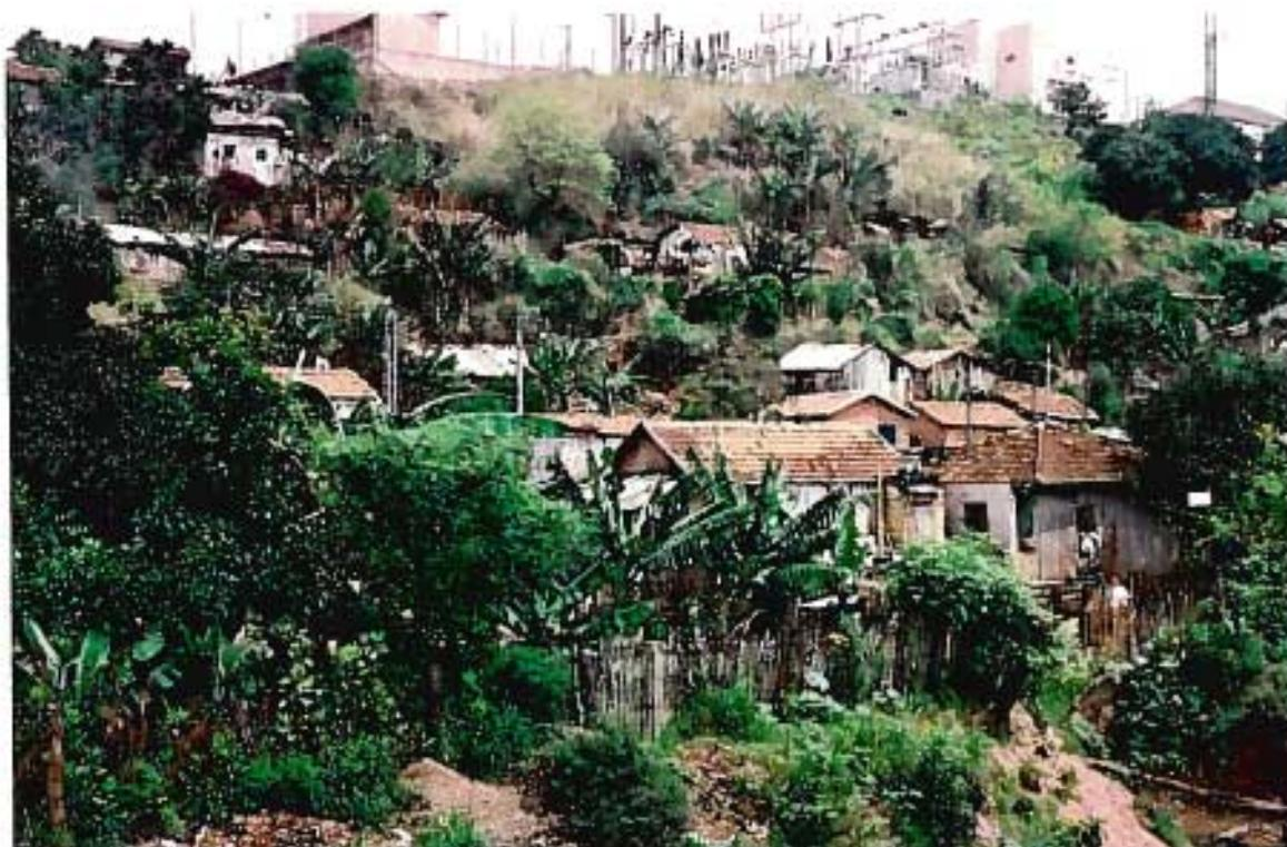
Foto 11 - Aspecto de ocupação desordenada em área com muito alta declividade, sujeita a escorregamentos, queda e rolamento de blocos, em escarpa com afloramentos de rocha na margem do Ribeirão Ourinhos. Requer medidas corretivas emergenciais.
