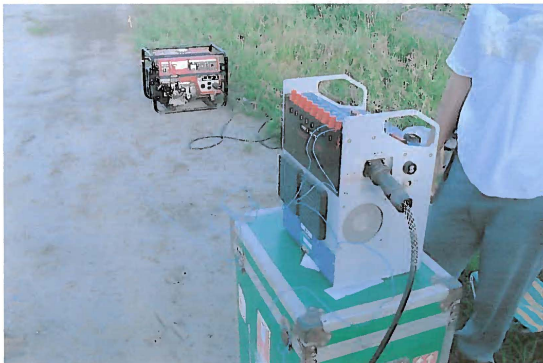
Foto 1 – Transmissor de corrente VIP3000W em primeiro plano e o gerador Honda EM5000S.
