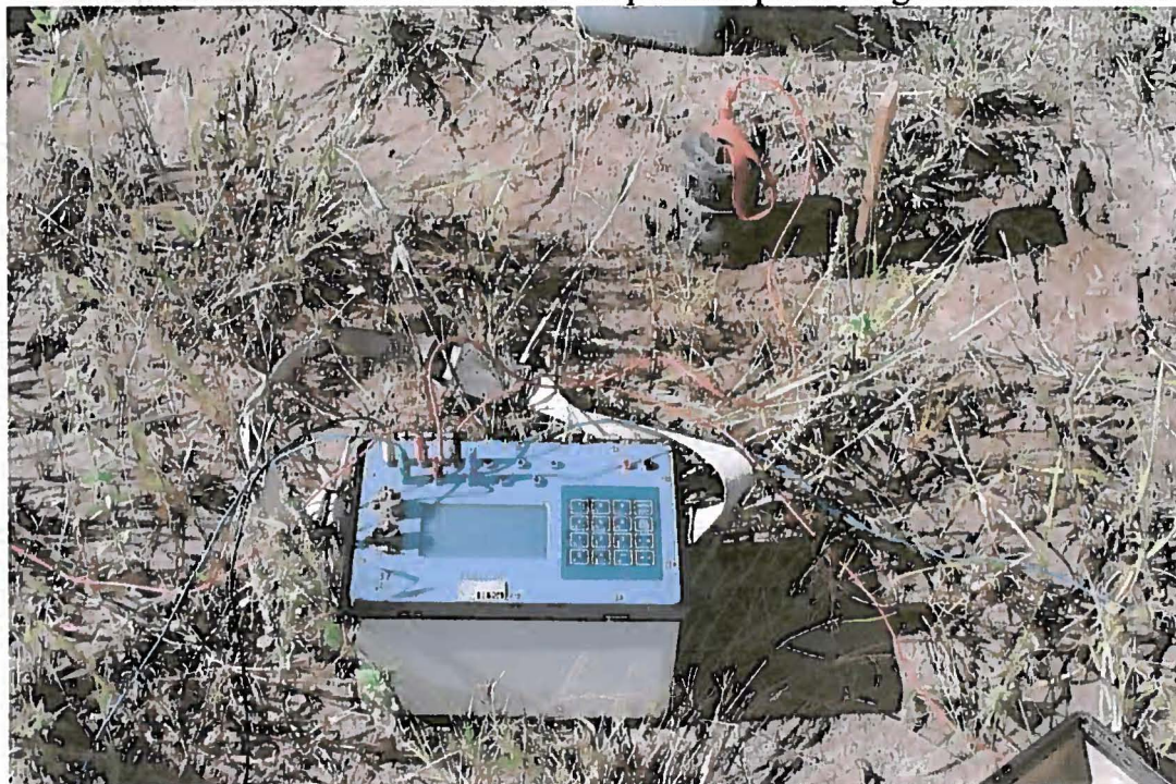
Foto 2 – Receptor multicanal e espectral ELREC10 e o eletrodo de potencial não polarizável.
