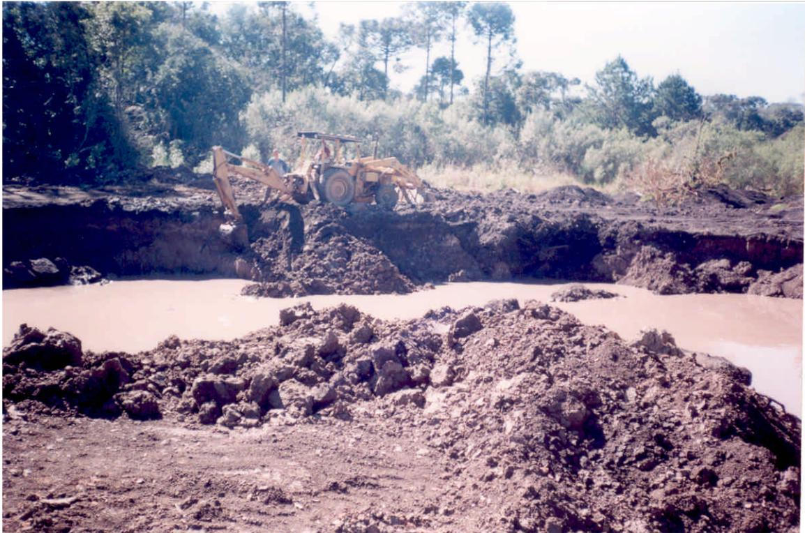
**Foto 03** – Área de extração de argila de banhado para mistura na massa cerâmica (ponto IB-04)
