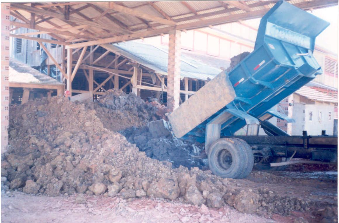
**Foto 9** – Mistura de argilas provenientes de “*taguás*” e de banhados na Cerâmica Zampier (ponto IB-03)
