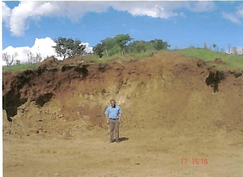
**Foto 03 – Saibreira. Dique de diabásio alterado, utilizado para retirada de material para recobrimento de estradas secundárias.**
