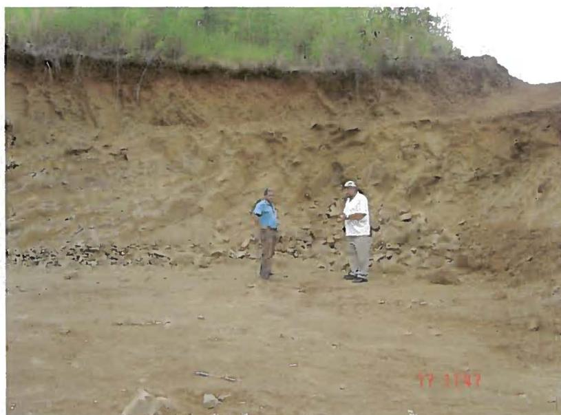
Foto 02 – Saibreira. Retirada de diabásio alterado para recobrimento de estradas municipais.
