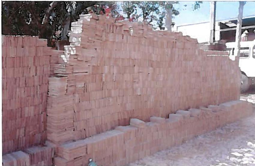
**Foto 17 – Placas de arenito Botucatu de Ribeirão Claro, afeiçoadas, prontas para polimento e acabamento, para pisos e revestimentos de residências. Em Rosário existe matéria-prima semelhante**
