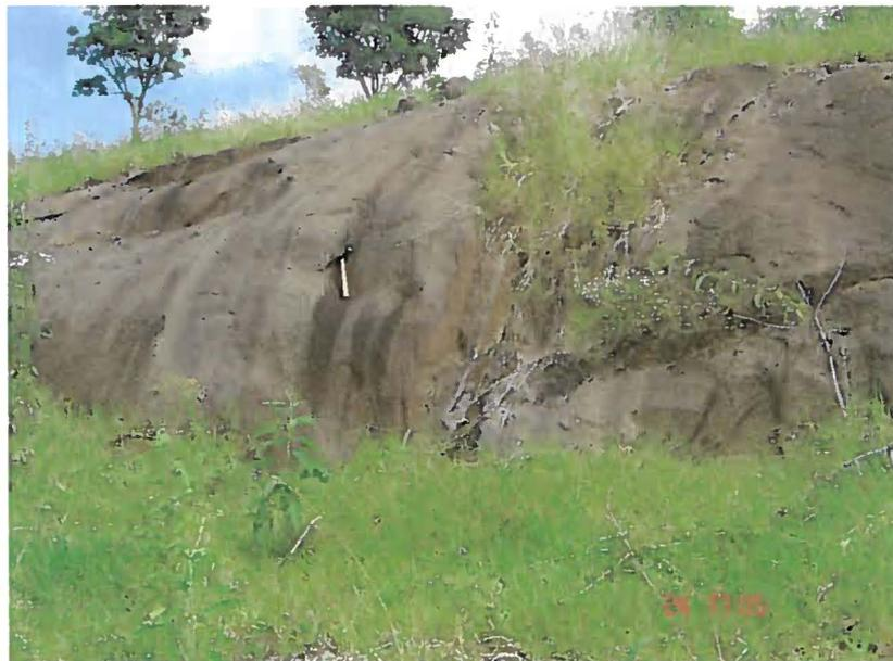
**Foto 10 – Dique de Diabásio maciço, compacto, duro e resistente, próprio para a implantação de uma pedreira para obtenção de brita e pedras irregulares para calçamento. Pé de galinha.**
