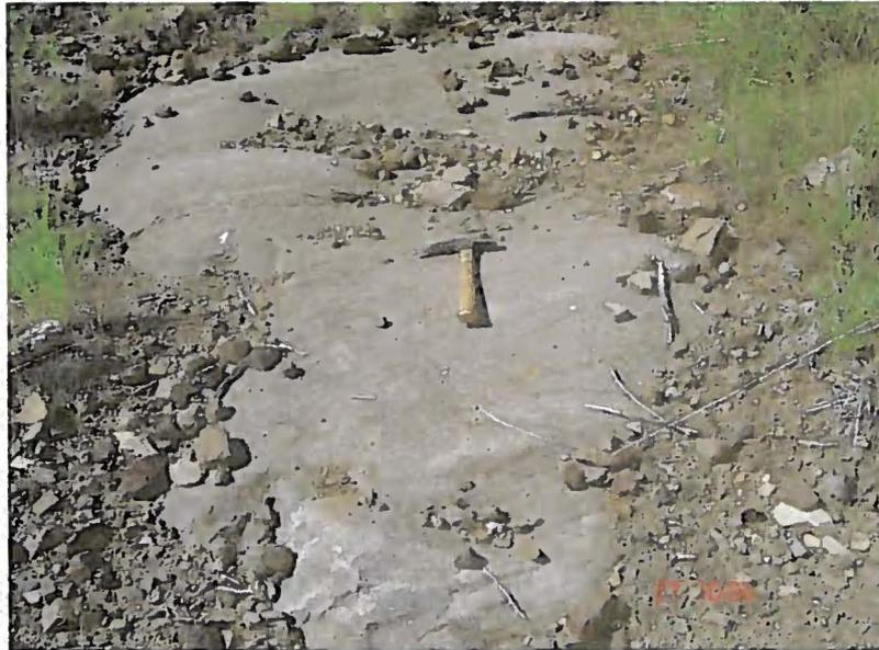
Foto 11 – Antiga pedreira da PM, local onde foi retirada a parte alterada do topo, ficando a porção dura e resistente, própria para pedreira de brita e pedras irregulares. Volta Grande, norte do município.
