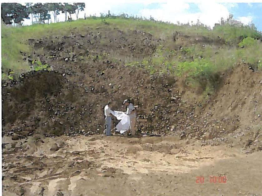
Foto 06 – Dique de diabásio alterado. Material próprio para recobrimento de estradas secundaria.
