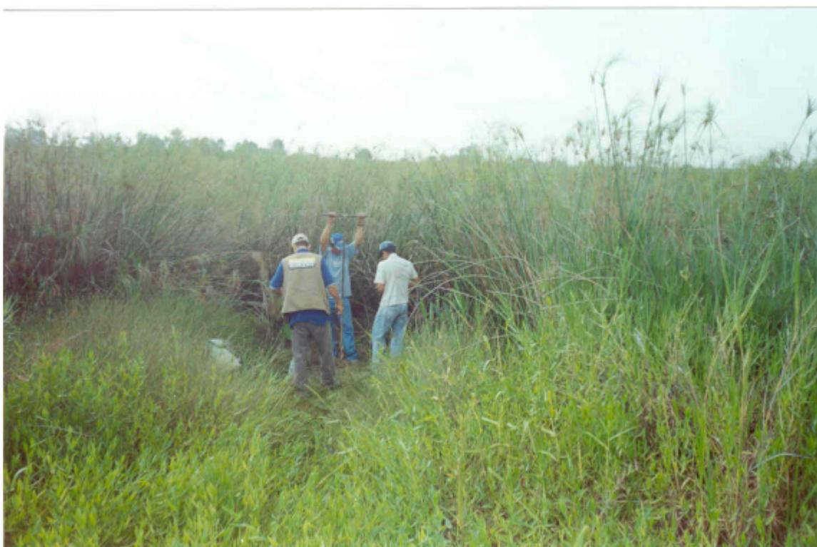
**Foto 14** – Furo à trado para coleta de amostras de argila na várzea do rio Jangada, próximo à barra com o rio Piquiri (ponto IP-25).
