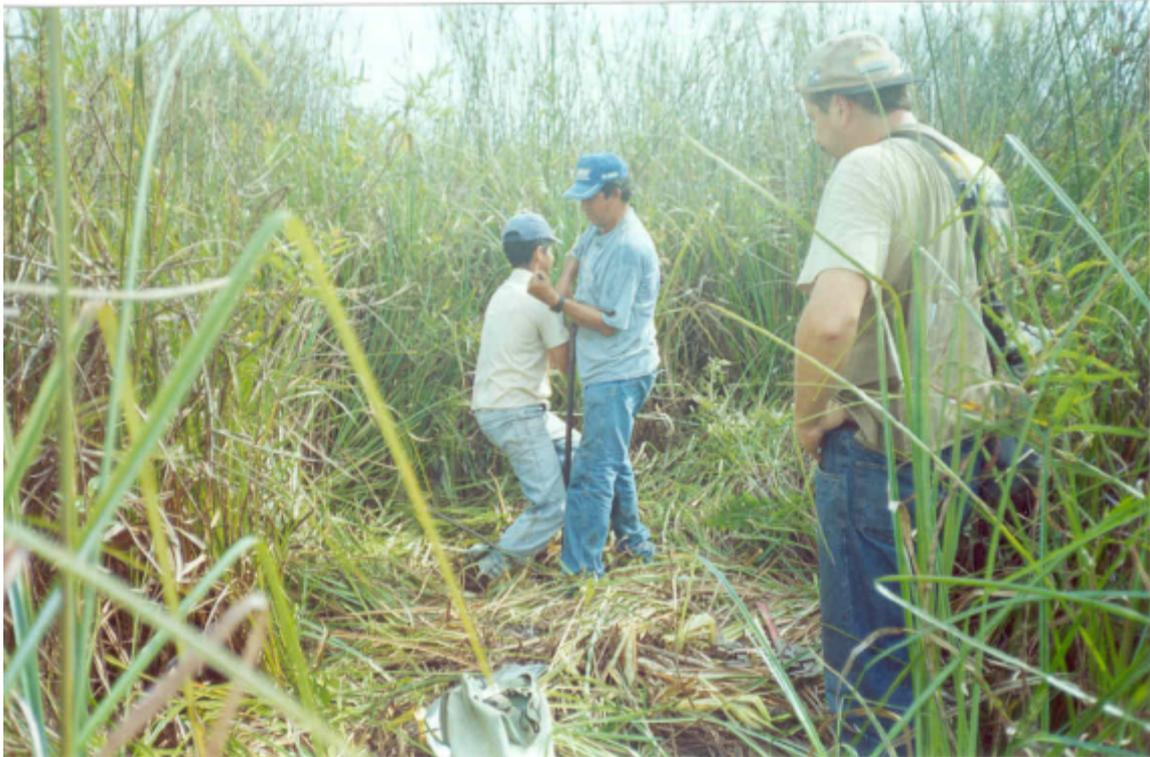
**Foto 15** – Realização de furo à trado para coleta de amostras de argila na várzea do rio Jangada (ponto IP-25)
