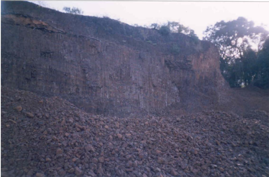
**Foto 9** – Aspecto dos basaltos extremamente fraturados com exploração de saibreira (ponto TU-04).
