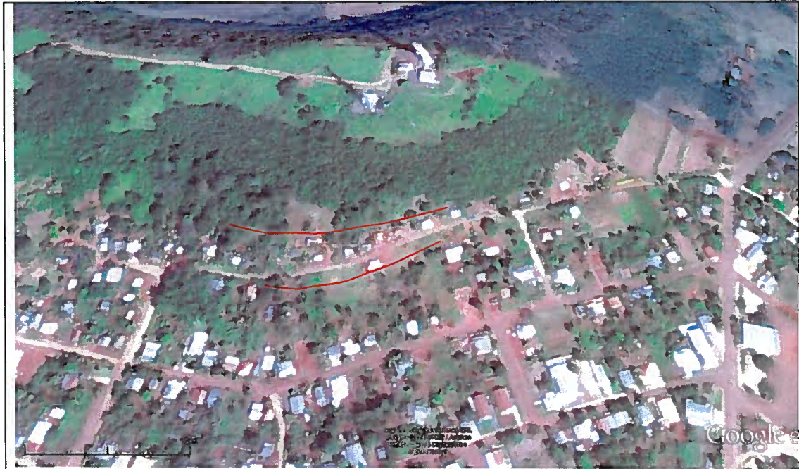
Figura 1. Imagem da encosta instabilizada sobre a Rua Cauã. Linha vermelha: localização aproximada das trincas.
