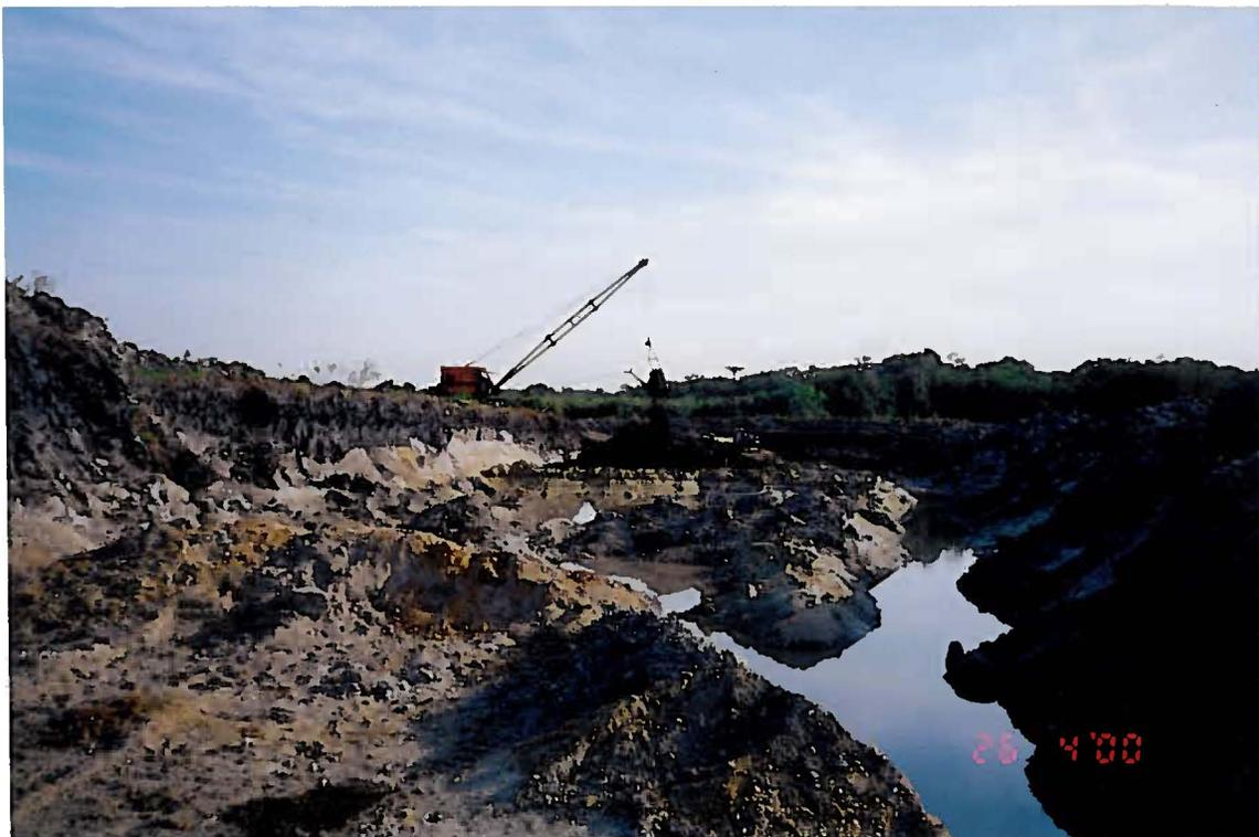
**Foto 04** – Método de lavra por desmonte a seco executado por “dragline”, na confluência do rio Verde com o rio Iguaçu, na divisa dos municípios de Araucária e Balsa Nova.
