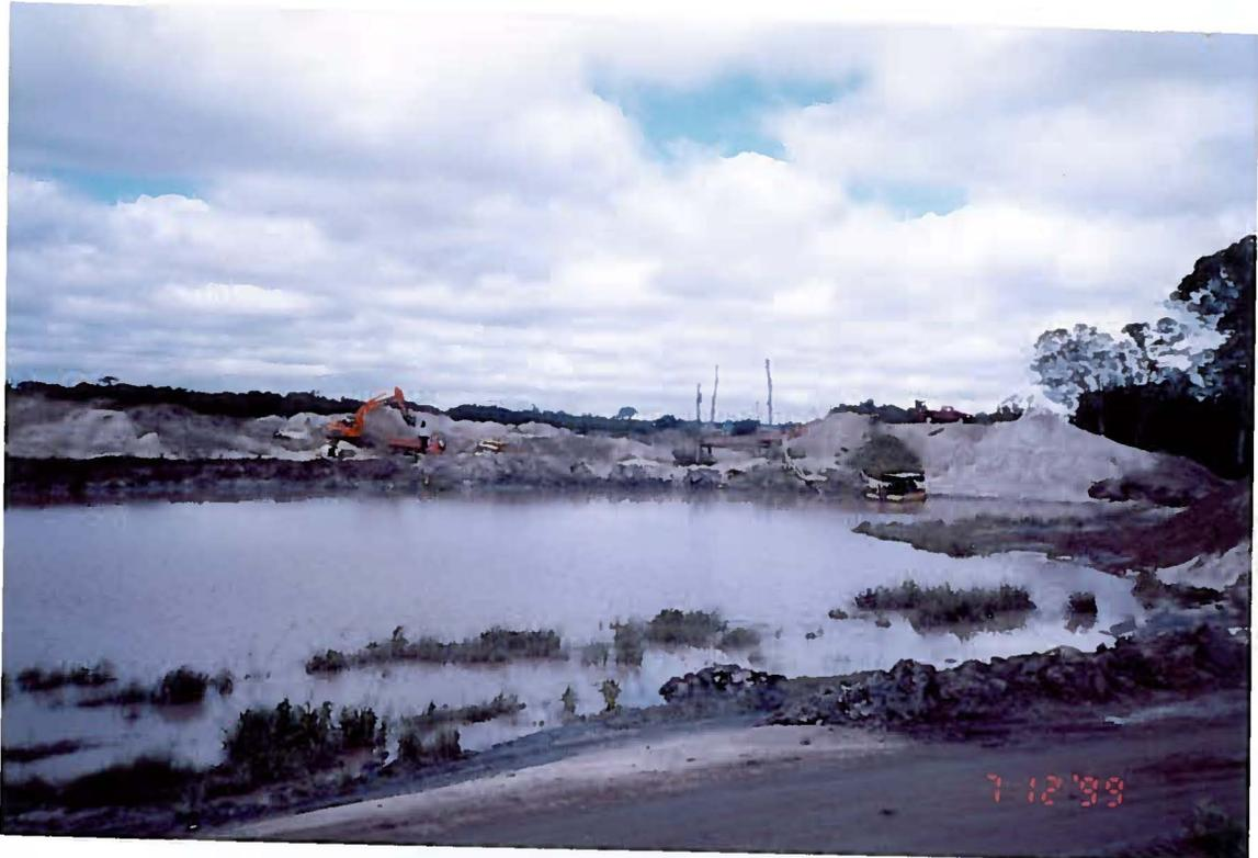
**Foto 05 – Aspecto de lavra por desmonte a seco, com escavadeira hidráulica, até o nível freático e utilização de draga na cava inundada, na região do bairro Umbará em Curitiba.**
