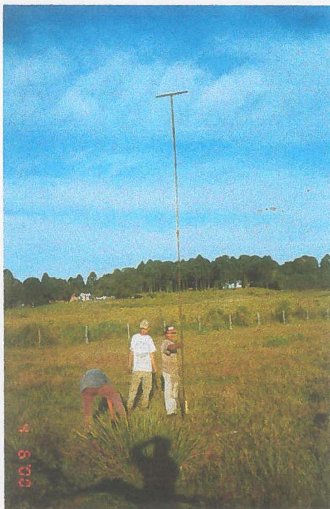
**Foto 04 – Parte central da area. Ponto 1900/LB. Furo com 5 metros de profundidade, onde 4 metros são de material cinza claro, cremoso, inconsistente, aparentando-se mais em forma de pasta aquosa do que em forma de argila. Deste tipo de material surgiu a denominação de furos “indefinidos”. Mostra-se com a altura da haste, a profundidade relativa do furo.**
