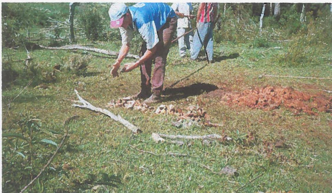
**Foto 03 – Parte central da area. Ponto 1.000/100 N. Perfuração de furo a trado, mostrando solo argiloso avermelhado (2 metros), com sequência argilosa, de cor cinza clara (3 metros). Observa-se a disposição sistemática do material argiloso retirado do furo, para descrição e amostragem.**
