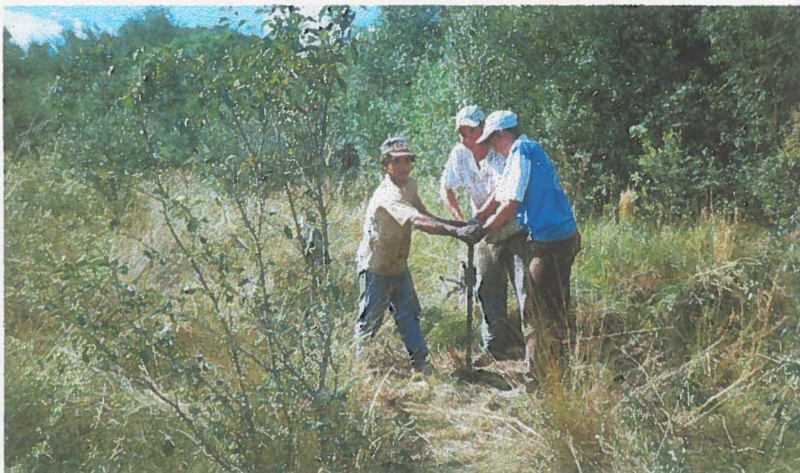
**Foto 01 – Demonstração de perfuração com trado manual. Ponto 400/600 N. Area de planície aluvionar, próximo à mata galeria do Rio Borboletinha.**
