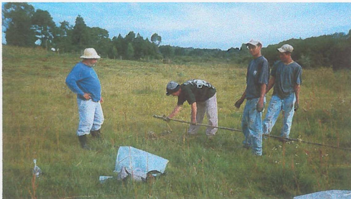
**Foto 02 – Demonstração da retirada de argila do trado manual, para posterior amostragem. Argila cinza. Ponto 50/500 – limite leste da area de Borboletinha.**
