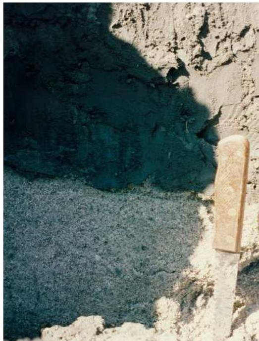
Figura 5 - Contato da argila com camada de areia.
