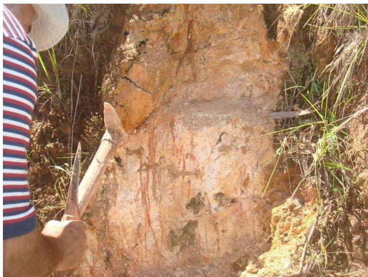
Figura 25 - Argila caulinitica muito fofo, que no projeto é denominada argila "podre", encontra-se entre os saprólitos dos gnaisses-migmatitos. Trata-se de rocha hidrotermalizada e intemperizada.
