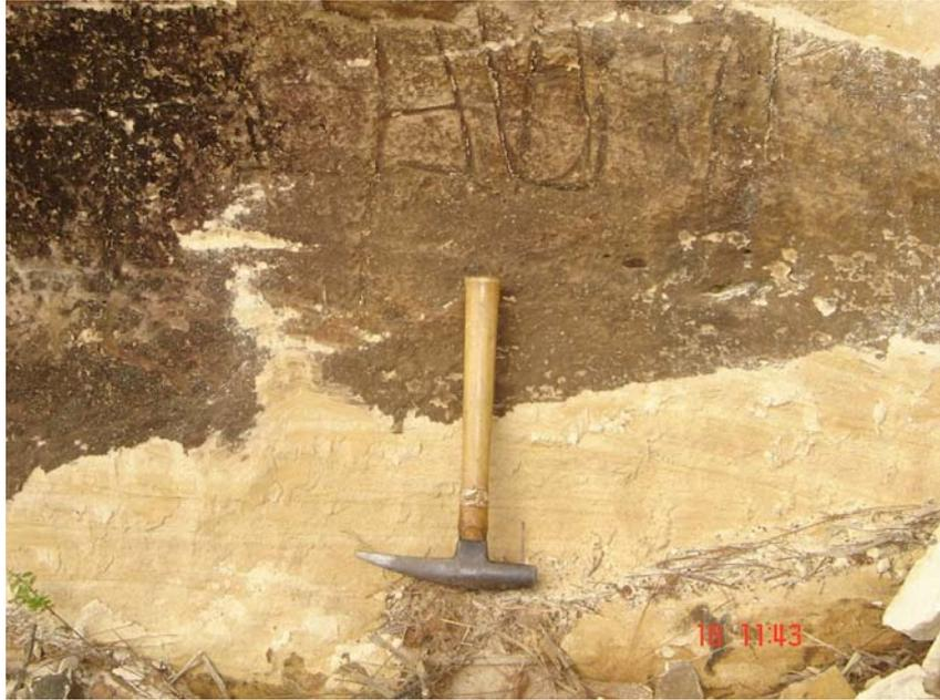
Foto 07 – AC 1246 – Arenito da Formação Botucatu. Granulometria fina a média, friável, alterado e de cor amarelo/avermelhada. Estrada de Faxinal da Boa Vista para Jaciaba.
