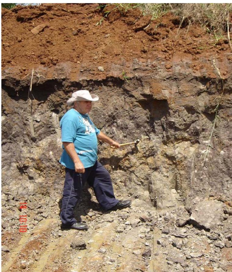
Foto 12 – AC 1189 – Frente de lavra da cerâmica DK, com aproximadamente dois metros de espessura: solo marrom no topo, argila cinza escuro e areia fina na base.
