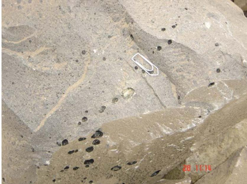
Foto 21 – AC 1127 - Basalto maciço, cor cinza esverdeado, apresentando pequenas cavidades preenchidas por vidro vulcânico. Pedreira da Comercial Ivaiporã. Produção principal de brita para construção civil.
