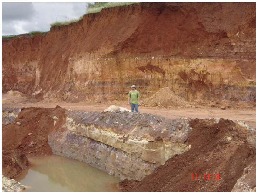
Foto 09 – AC 1202 – Vista geral do barreiro das cerâmicas Mazzuco e Marim Mazzuco. Argila marrom escuro com níveis claros pouco arenosos da Formação Rio do Rasto. Cândido de Abreu/Manoel Ribas – PR.
