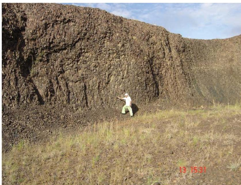
Foto 24 - AC 1240 – Pedreira de basalto alterado, denominado “moledo” muito usado para recobrimento de estradas vicinais e para asfaltos em rodovias. Estrada Goiachim/Guarapuava.
