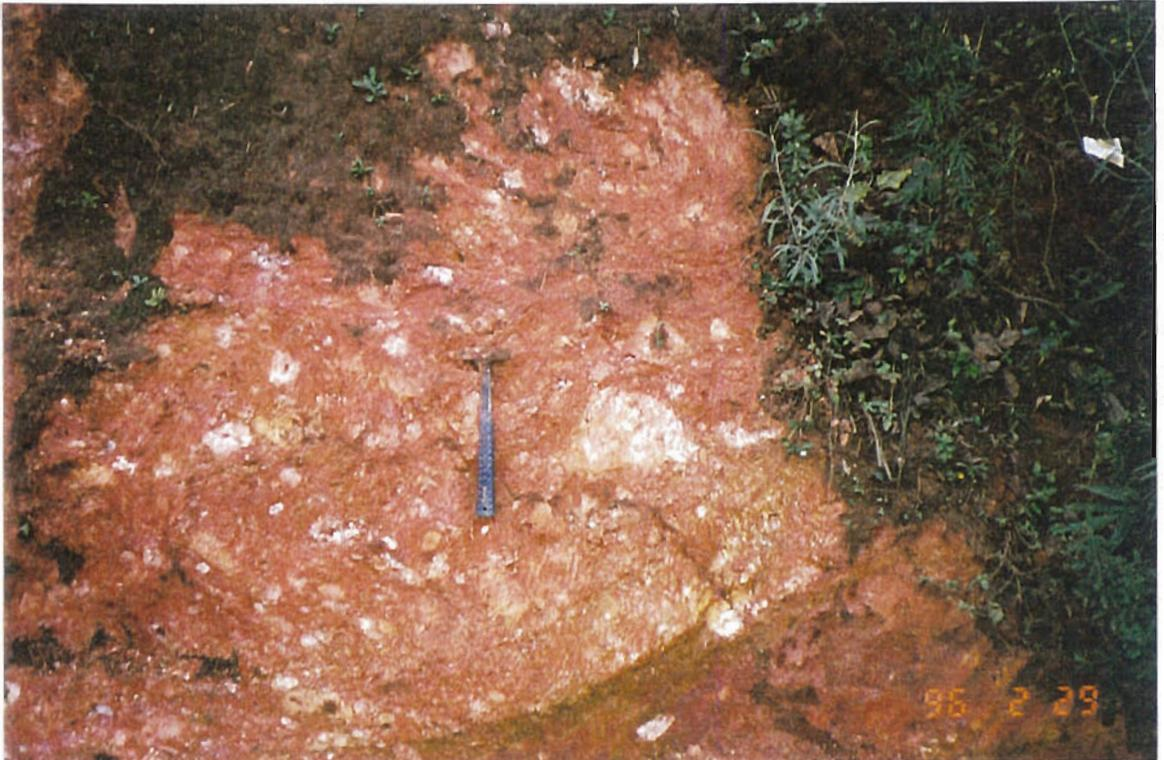
**Fotografia 09 - Folha A138, ponto SR-1843 - Brecha sedimentar da Formação Guabirota em contato com saprólito de gnaisses-migmatitos.**
