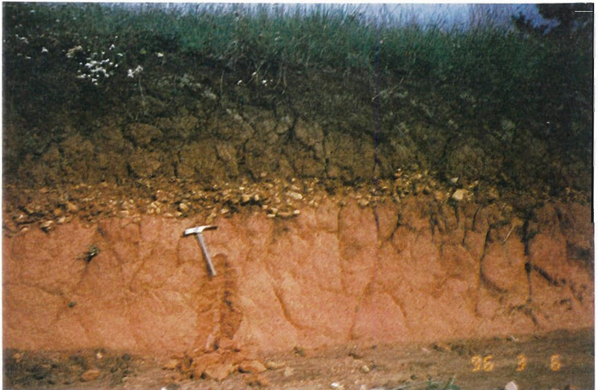
**Fotografia 13 - Folha A140, ponto SR-1901 - Solo transportado marrom escuro (parte superior) separado por um pavimento (linha de seixos) de fragmentos grosseiros de quartzo do saprólito de gnaisses-migmatitos na base.**
