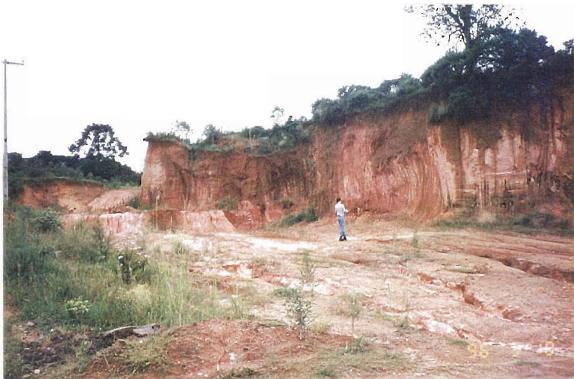
**Fotografia 14 - Folha A137, ponto OS-1172 - Solo residual maduro pouco espesso recobrimdo saprólito de gnaisses-migmatitos.**
