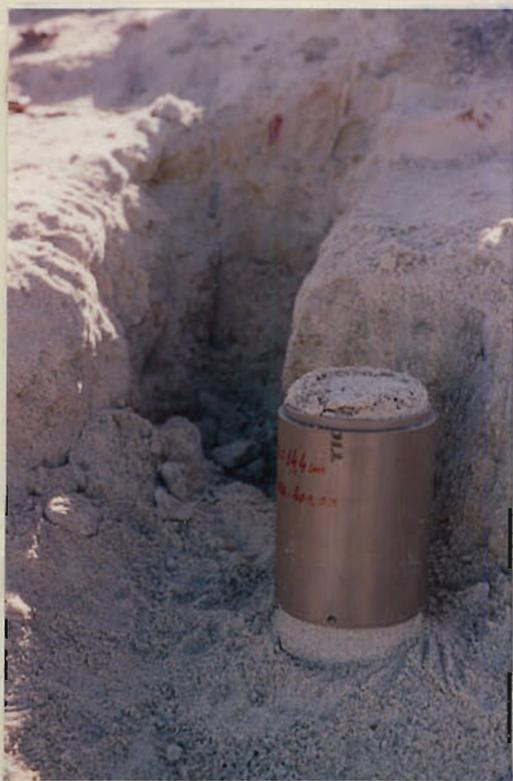
Fotografia 1 - Exemplo de amostragem geotécnica para ensaio de permeabilidade em arcósios da Formação Guabirotuba (OS-903).
