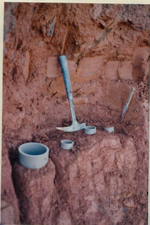
Fotografia 2 - Amostragem geotécnica em solos residuais para determinação de índices de campo (01 PVC médio) e de erodibilidade (03 PVCs) (OS-667).
