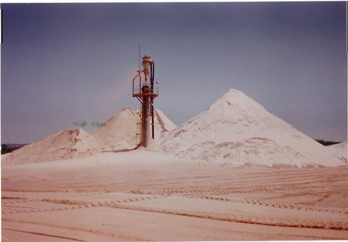
Foto 06: Pilhas de estocagem, notar que a coluna tem ciclone para separação.
