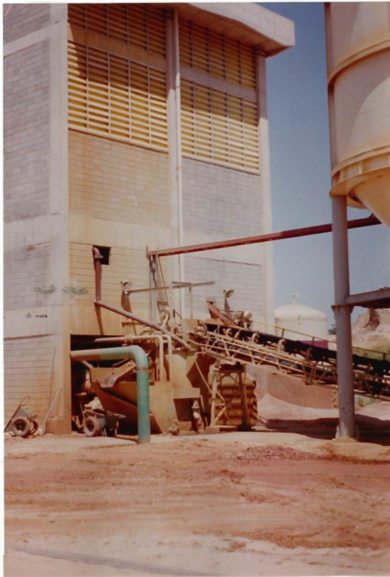
Foto 04: Separação com grelha antes do prédio de separação granulométrica.
