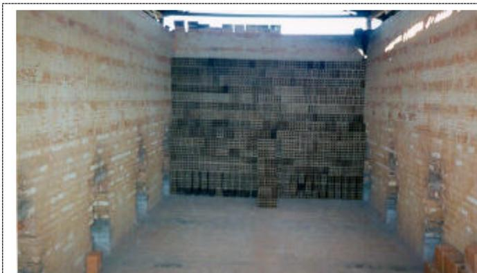
Foto 4: O interior de um forno caipira, da mesma olaria da foto anterior. Neste tipo de forno, a alimentação de lenha é na altura do chão do forno.
