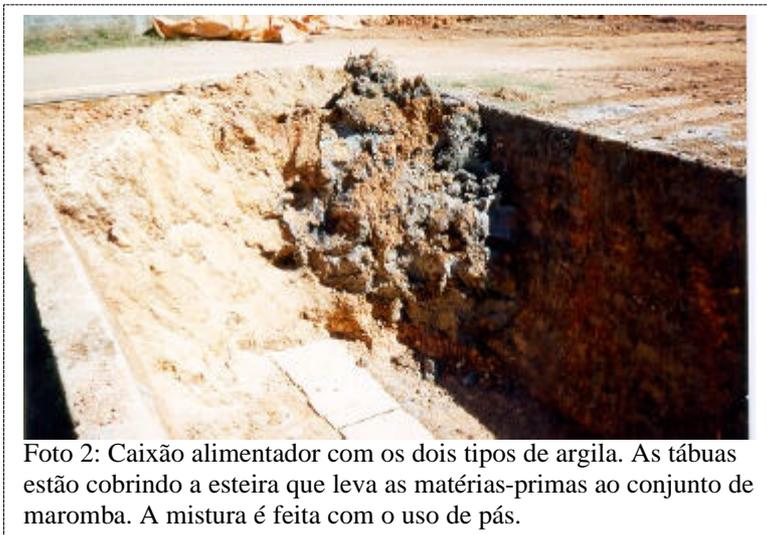
Foto 2: Caixão alimentador com os dois tipos de argila. As tábuas estão cobrindo a esteira que leva as matérias-primas ao conjunto de maromba. A mistura é feita com o uso de pás.
