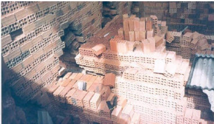
Foto 6: O interior de um forno caipira, muito mal cuidado, com os tijolos mal empilhados.
