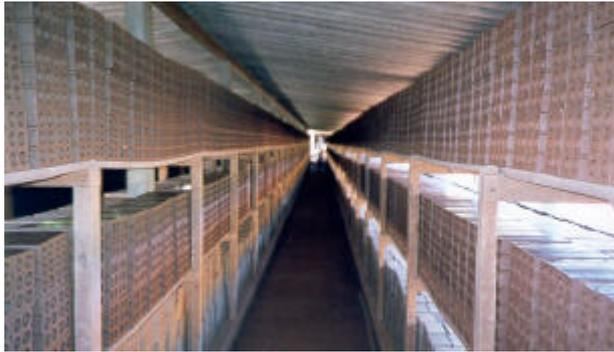
Foto 3: O interior de um "estaleiro", que é como se chamam as construções alongadas que servem para os tijolos secarem antes de irem para os fornos. Neste caso, é uma olaria bem cuidada, podendo ser observado na limpeza do corredor.
