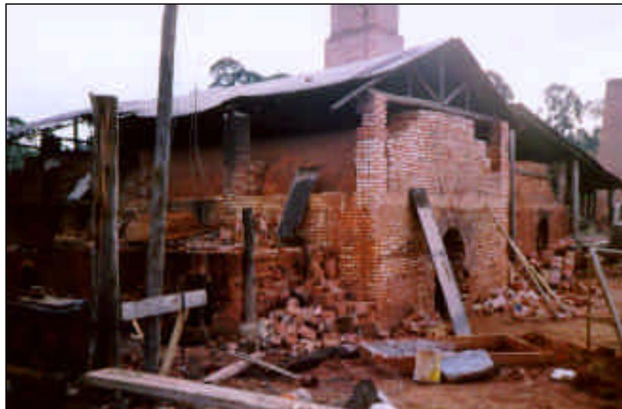
**Foto 20** : Uma das três olarias que funcionam no município, utiliza siltitos da formação Palermo na fabricação de tijolos.
