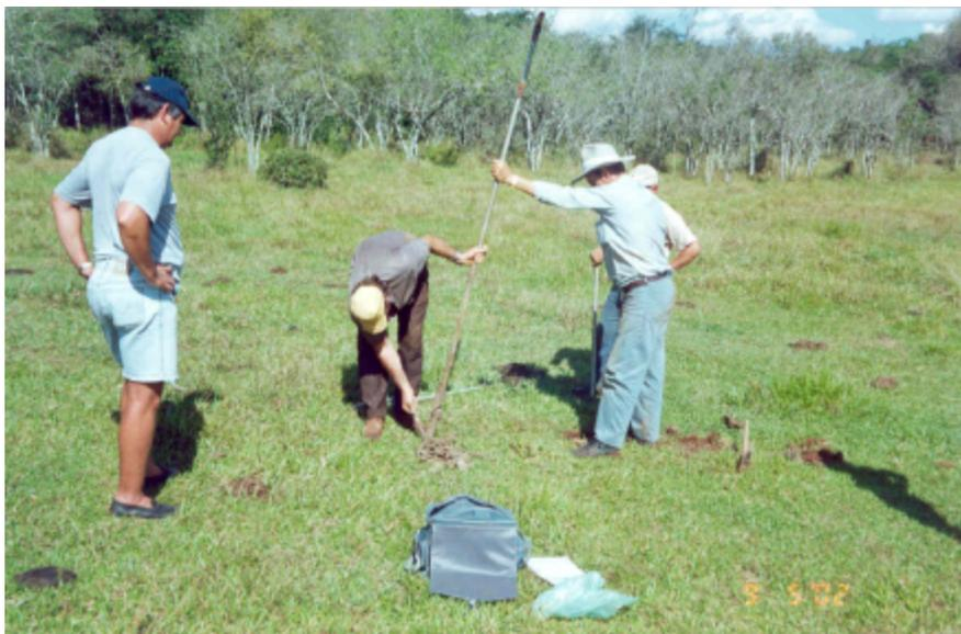
Foto 01 – Pesquisa de argila com o uso de trado manual, ponto LL-591. O furo atingiu 4,5m de profundidade sem atingir o final do “pacote” de argila (argila tipo 6).
