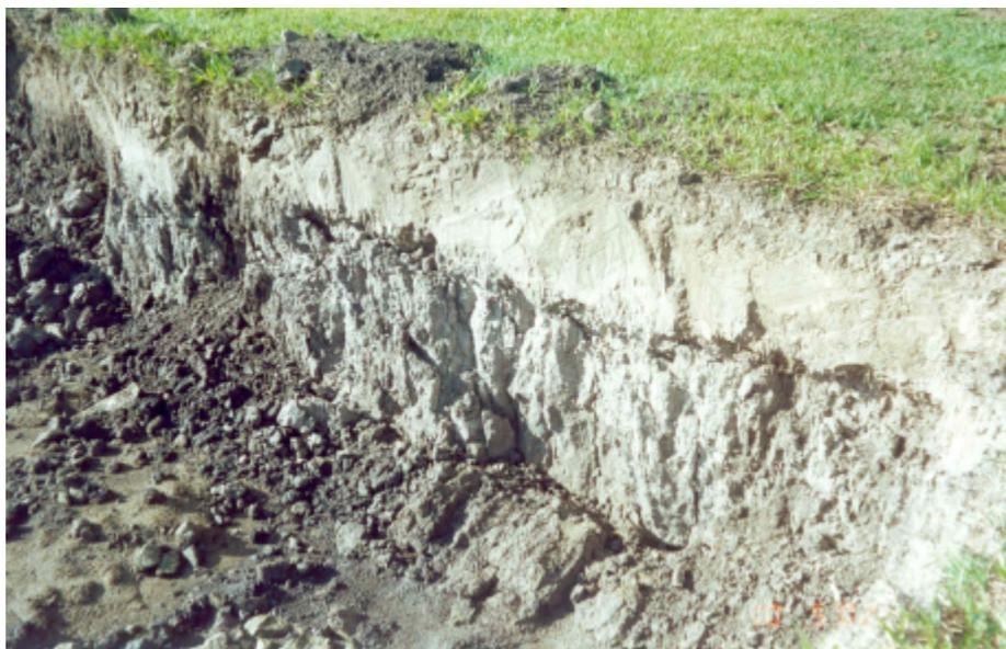
Foto 06 – Observe o típico perfil de argila (tipo 7), detalhe da foto anterior. Na porção superior do perfil observa-se o solo arenoso.
