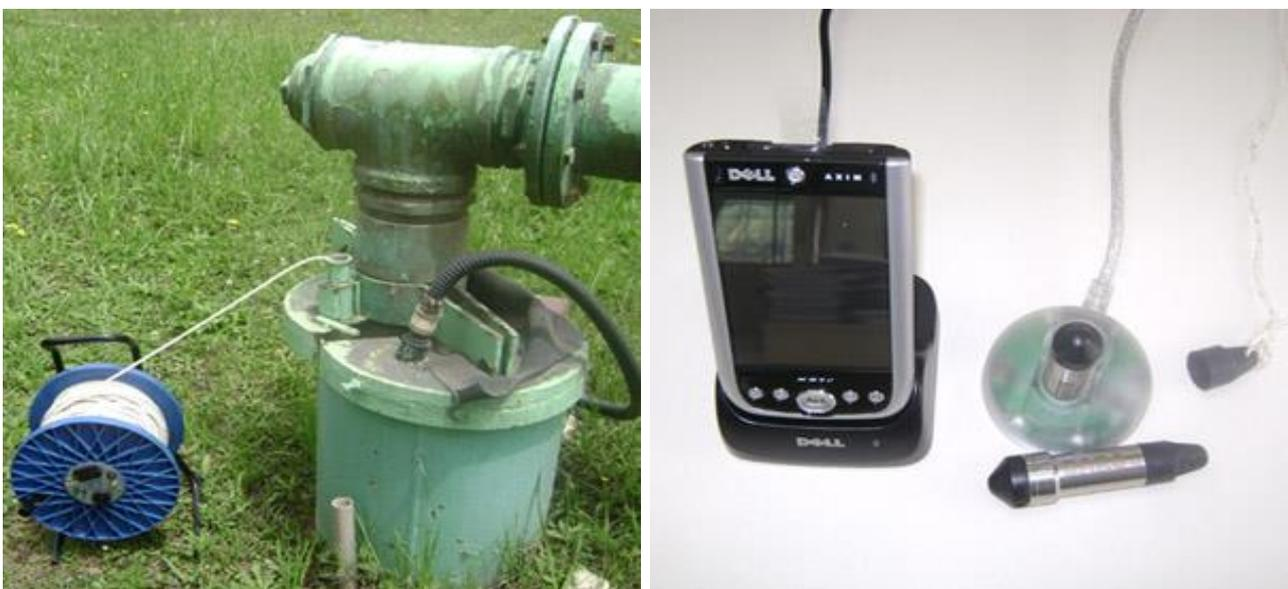
*Figura 19. Medidores de nível dinâmico de aquíferos, medidor manual (esquerda), medidor automático (direita). (Fonte de imagem: Sanepar)*
