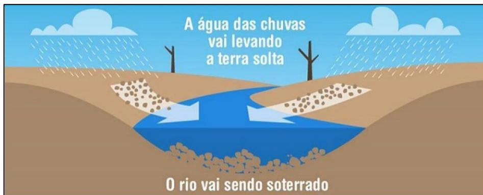
Figura 10. Processo de assoreamento de cursos hídricos superficiais (Fonte de imagem: PUC Minas).
