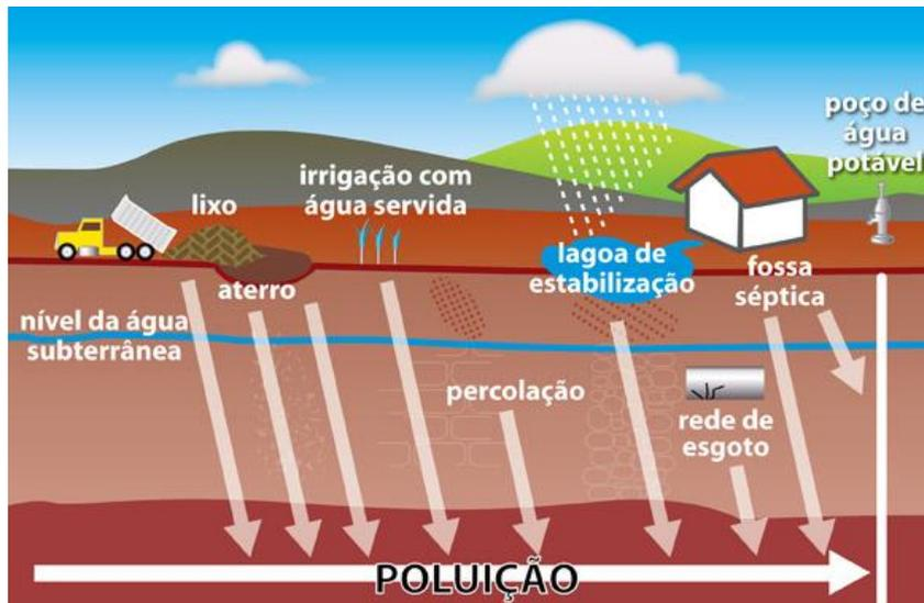
Figura 18. Fontes de poluição e contaminação de aquíferos (Fonte de imagem: DAE/Bauru/SP).
