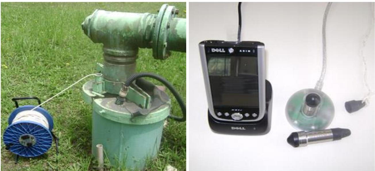
*Figura 22. Medidores de nível dinâmico de aquíferos, medidor manual (esquerda), medidor automático (direita). (Fonte de imagem: Sanepar)*
