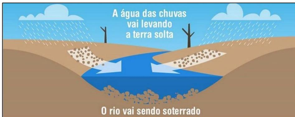
Figura 13. Processo de assoreamento de cursos hídricos superficiais (Fonte de imagem: PUC Minas).
