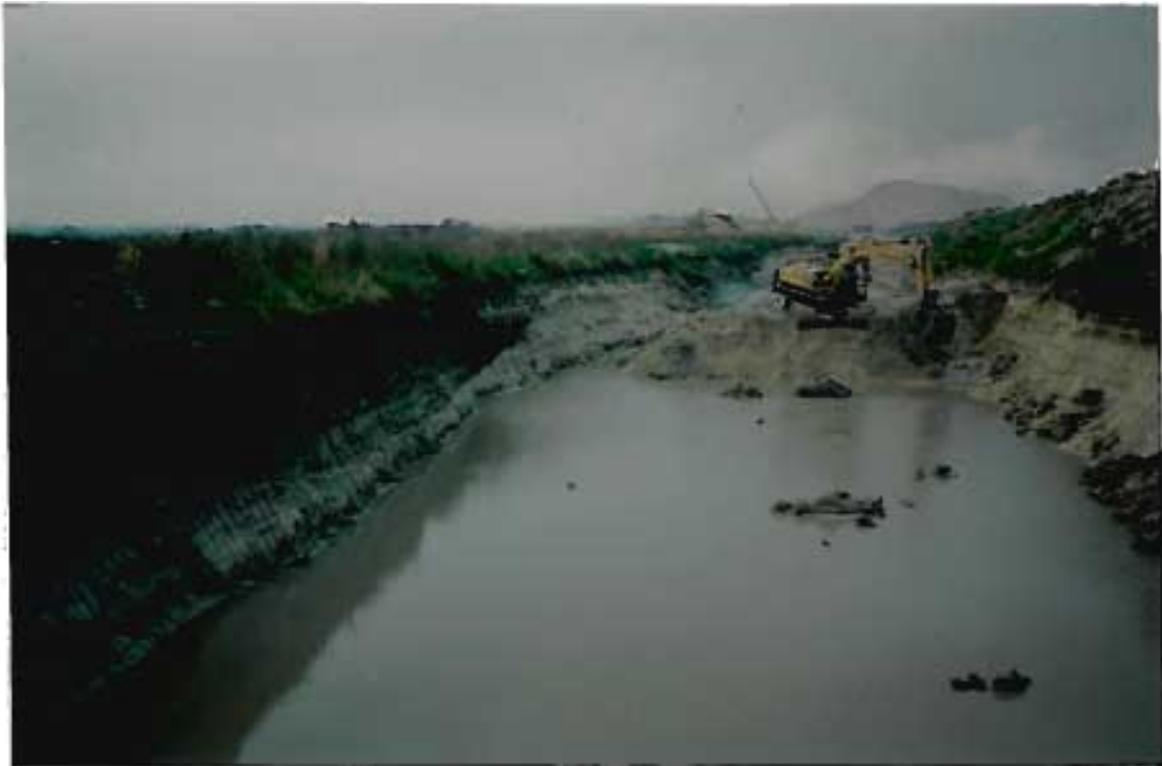
Foto 35: Exemplo de uma cava em lavra. A drag-line já dragou o material estéril e, a escavadeira hidráulica retira a areia. Notar a diferença da espessura do banco de areia.
