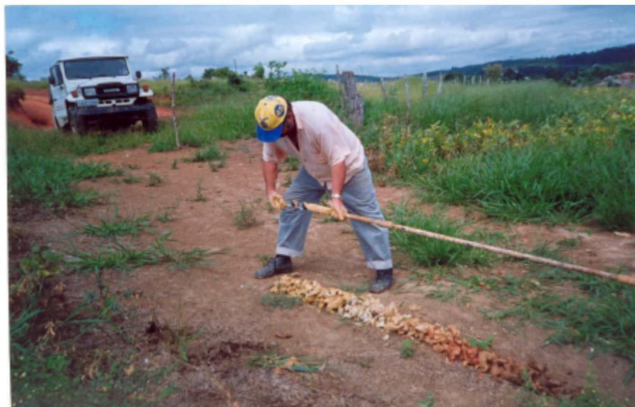
Foto 12 –Área F furo 02 – Disposição do material argiloso recuperado na perfuração a trado manual, mostrando a sistemática de amostragem e a qualidade da matéria-prima.
