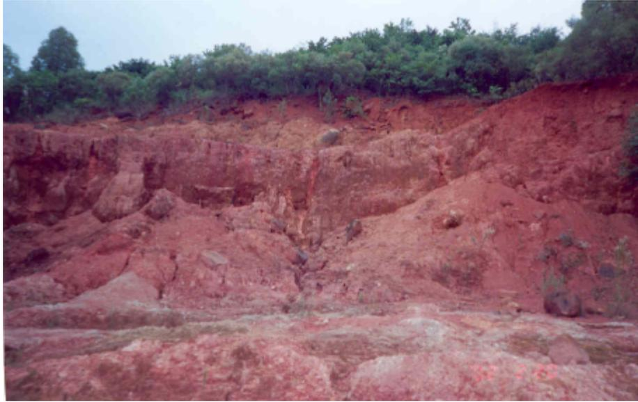
Foto 09 – Lavra de argila interrompida pela presença de dique de diabásio, muito comum na região de Ortigueira. A presença destas estruturas deve ser detectada antes do início de qualquer lavra de argila na região.
