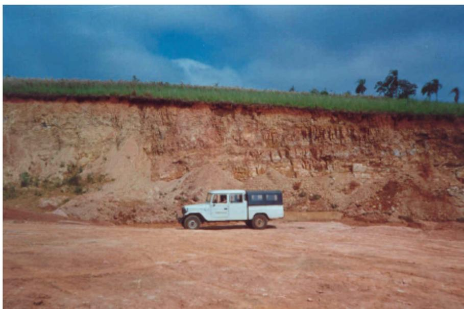
Foto 04 –Frente de lavra mostrando as características próprias da matéri-prima utilizada na obtenção de tijolos na região de Ortigueira. A espessura real é muito superior a esta, ultrapassando aos 10 metros.
