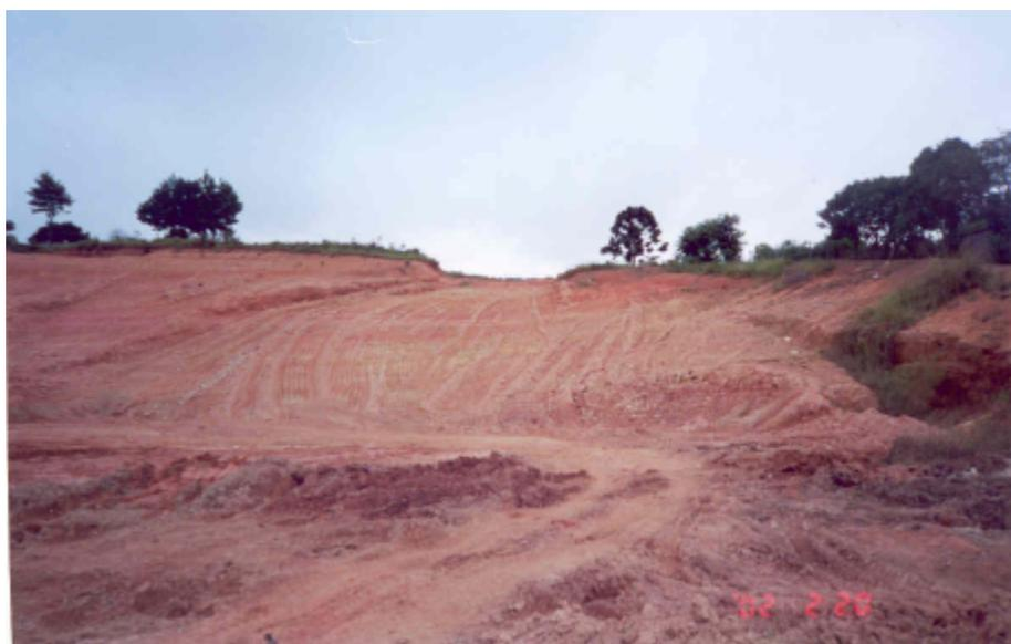
Foto 06 –Lavra orientada, no sentido de se fazer recuperação da área. Cerâmica São Carlos. Observa-se a grande exposição, espessura e volume da matéria-prima argilosa.
