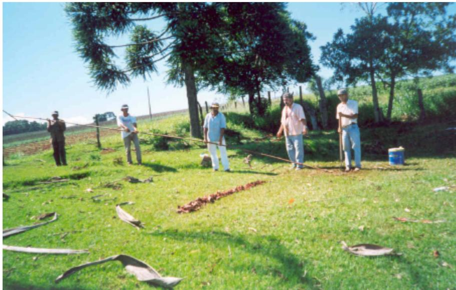
Foto 11 – Área J furo 01 – Cantão – Processo de abertura de um furo a trado manual, mostrando a disposição do material a ser amostrado e a profundidade que o furo pode alcançar, através da junção de hastes.
