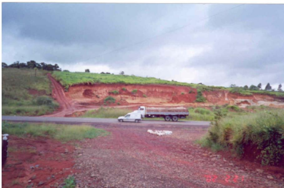
Foto 01 – Lavra do Cidão situada a 3 km ao sul da cidade, junto à BR 376. No alto, observa-se um dique de diabásio determinando o final da jazida.
