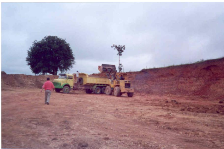
Foto 02 – Frente de lavra – barreiro da torre. Material argiloso (saprolito) de baixa consistência, sendo facilmente escarificado através de pá carregadeira.
