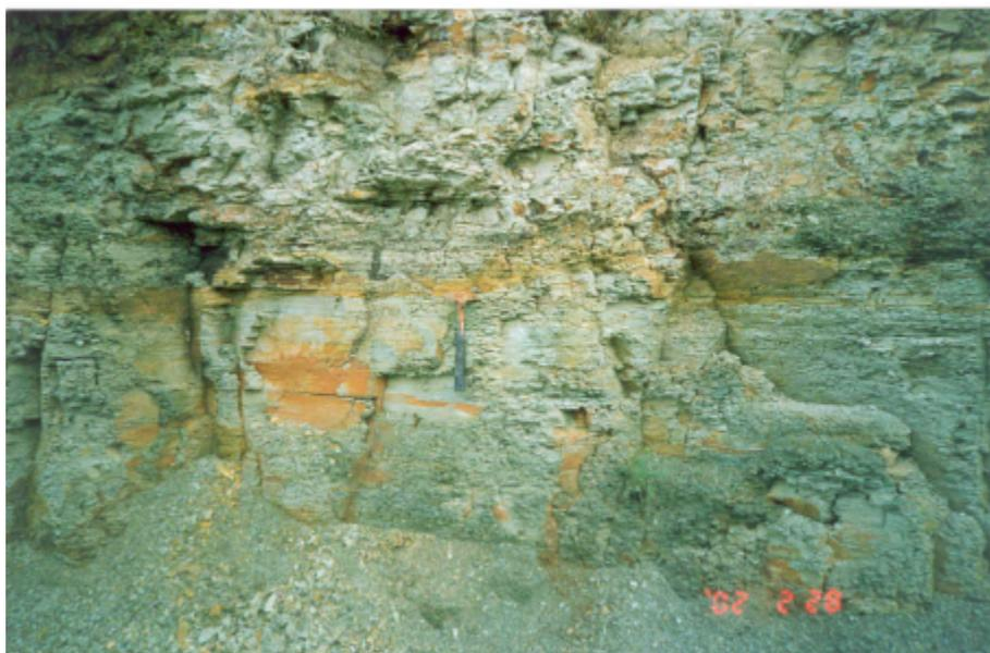
Foto 14 – Área H – norte da cidade – Exposição de rocha em corte de estrada, mostrando-se tratar de rocha dura, semi-alterada, não argilosa, imprópria como matéria-prima para uso em cerâmica vermelha.
