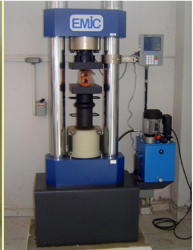
**Equipamentos novos – forno e prensa para análise de material cerâmico**
