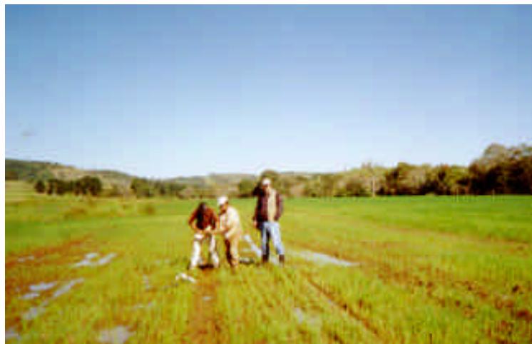
Foto 10. Exploração com furos a trado de argilas cinza, bastante plásticas, em área alagadiça na região de São Sebastião da Ivaí, estrada para Fênix (ponto BF-18).
