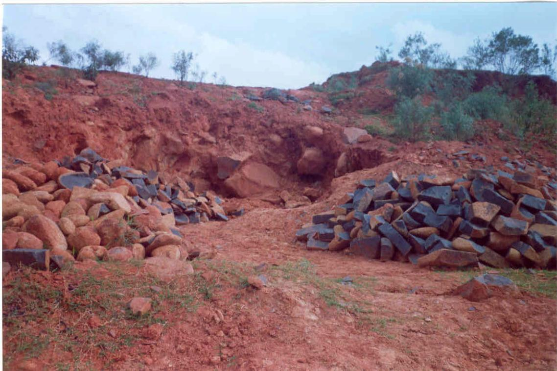
**Foto 26** – Detalhe da retirada de blocos de diabásio (ponto TI-55)
