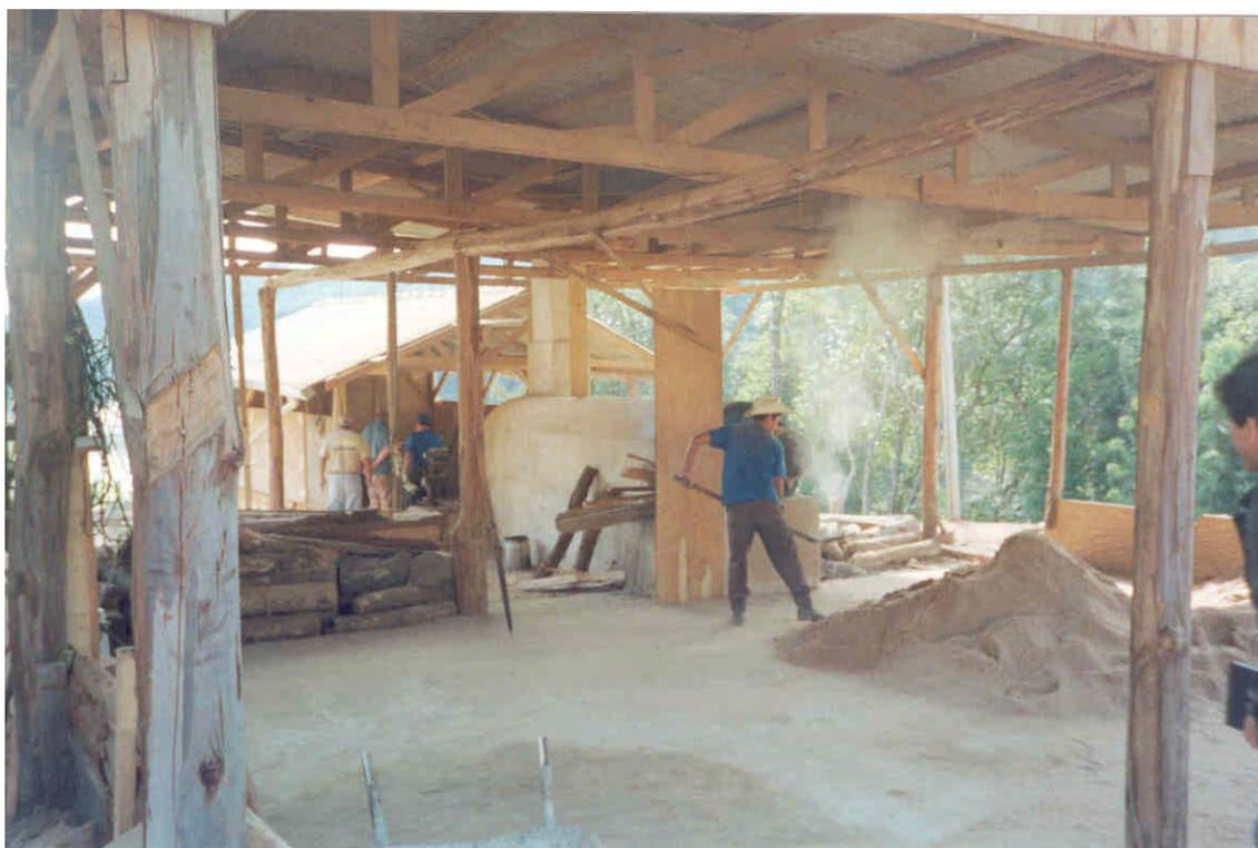
**Foto 40** – Processo de beneficiamento de areia por secagem e peneiramento (ponto TI-08)
