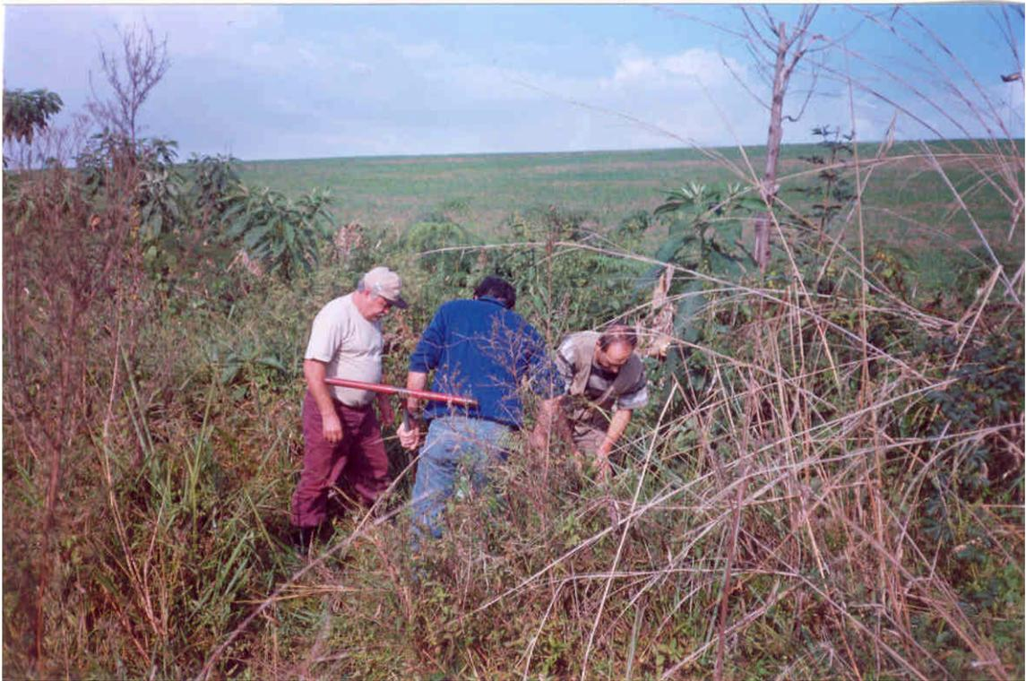
**Foto 65** – Realização de furo a trado em várzea do Rio Tibagi próximo a balsa (ponto TI-66)
