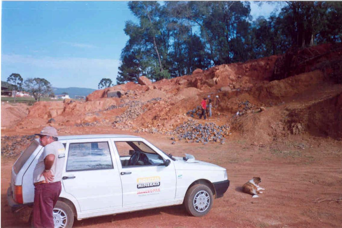
**Foto 27** – Exploração de diabásio para retirada de pedras irregulares para calçamento (ponto TI- 57)
