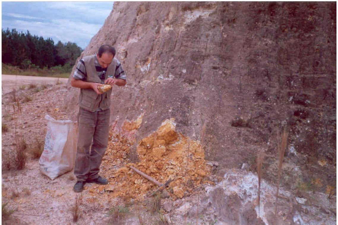
**Foto 30** – Coleta de material para peneiramento e concentração em bateia (ponto TI-58)
