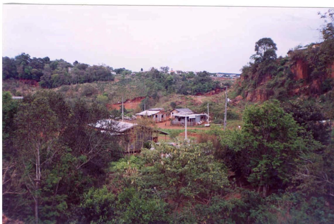
**Foto 20** – Detalhe de ocupação irregular na área da antiga pedreira, com evidentes riscos geológicos como queda de blocos (ponto LA-07)
