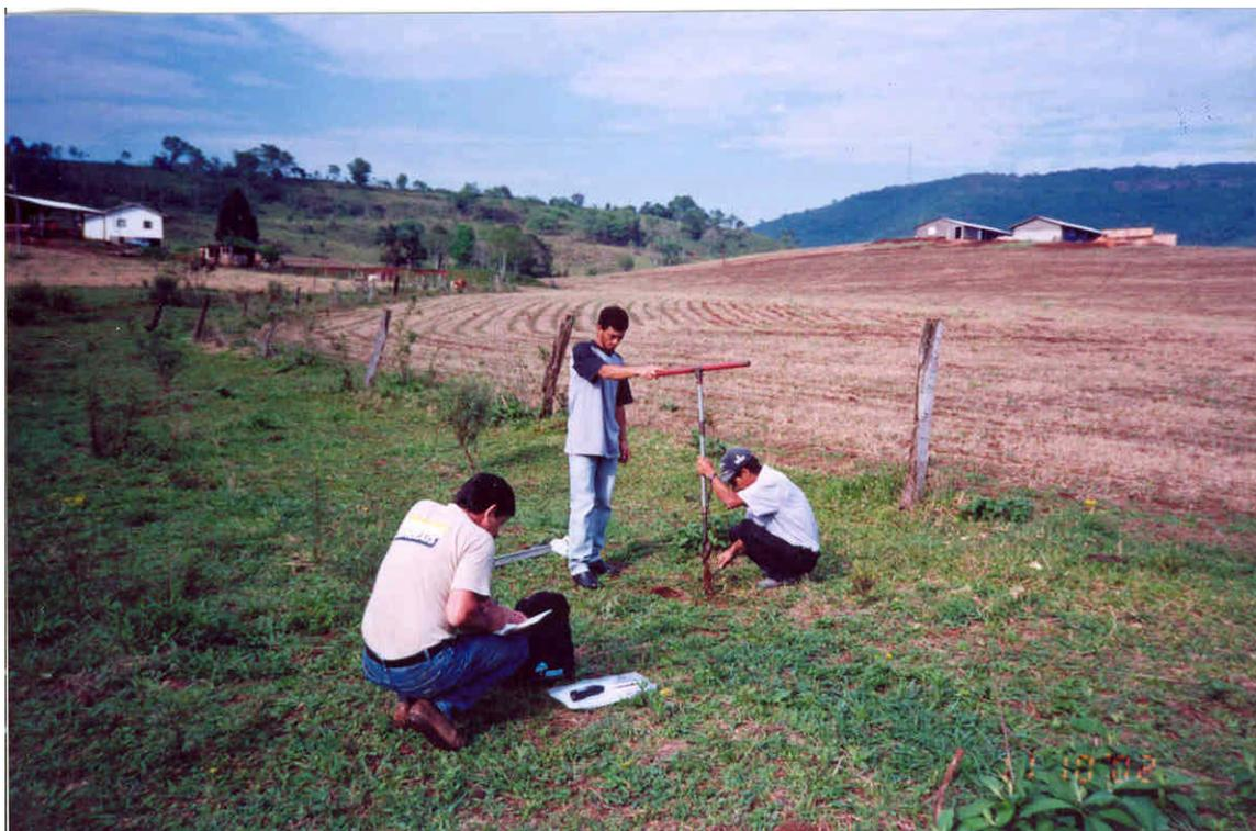
**Foto 38** – Detalhe de amostragem de argila para ensaios cerâmicos (ponto LJ-19)
