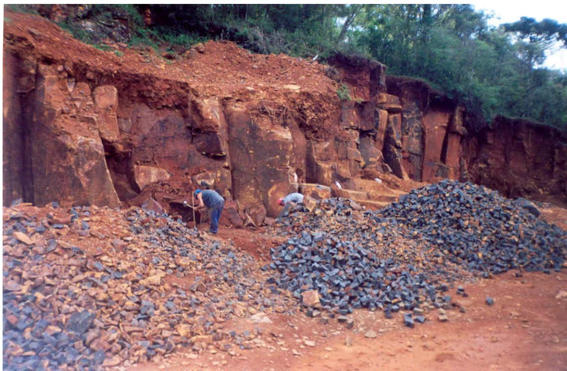
**Foto 12** – Detalhe da exploração de blocos para calçamento (ponto LA-07)
