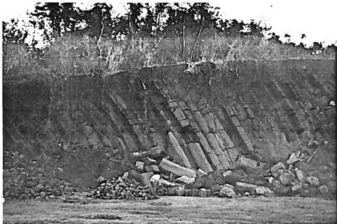
Foto 13: Obtenção de pedras de revestimento a partir de "colunas" de rocha básica. A disposição colunar das rochas facilita a lavra, dispensando explosivos - Tomazina-PR
