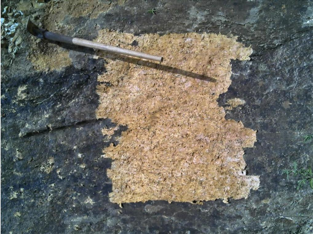
**Figura 7** – Detalhe das rochas graníticas alteradas (saprólito) mantém a estrutura da rocha original, cores claras.
