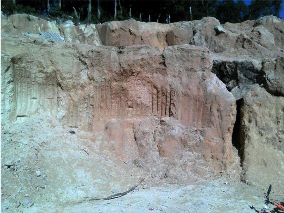
**Figura 9** – Detalhe de um corte em solo residual/saprólito do granito. Notar a baixa erodibilidade, ótimo como material de empréstimo.
