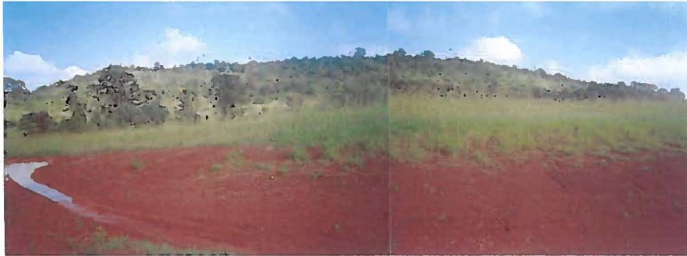
Foto 01 – Mb 1 – Vista geral da elevação junto ao rio Gavião, estrada para Guarani. Em primeira vista todo é perfeito para a implantação de uma pedreira de diabásio para o aproveitamento como brita para construção civil, porém se trata de diabásio amigdaloidal e vesicular, fraco, alterado e às vezes pulverulento, não apresentando características para aproveitamento como brita.
