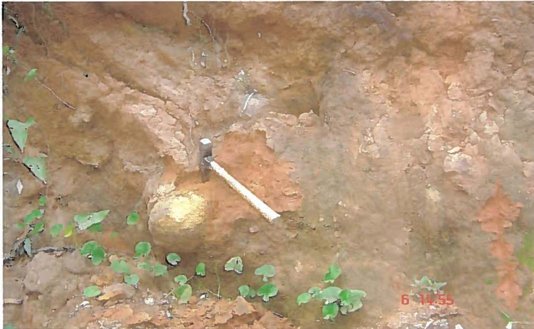
Foto 09 - Idem anterior, mostrando a relação entre massa alterada e a rocha, blocos alterados, dando a aderência necessária ao conjunto.
