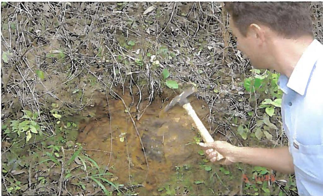
**Foto 03 Vicinal 2, próximo à Igreja de São Miguel Arcanjo. Barranco de estrada com aprox. 3 metros de altura, apresentando uma soleira de diabásio alterada, com blocos ainda inteiros, resistentes e muito material alterado, argiloso interalados, em boas condições para servir como macadame para estradas secundárias.**
