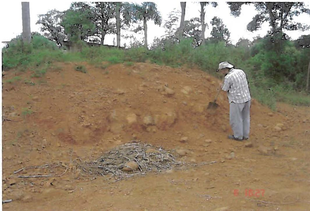
Foto 12 – ML 12-A –Sítio do Gilmar Santos. Pequena soleira de diabásio alterado, próprio para implantação de saibreira. Muitos blocos alterados, pequenos e intercalados a matriz argilosa, combinando para dar a liga de sustentação da estrada cascalhada.
