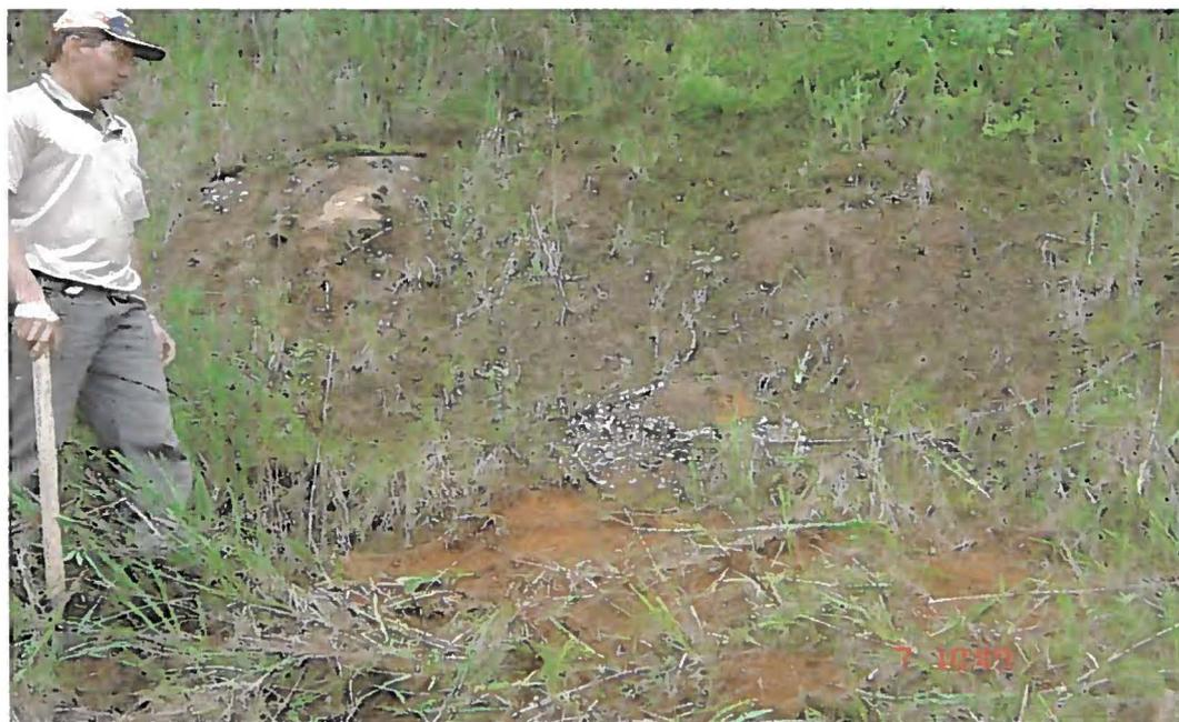
Foto 22 – ML 17-C – Mesma estrutura, indicando uma grande área com material adequado para obtenção de saibro para revestimento de estradas.
