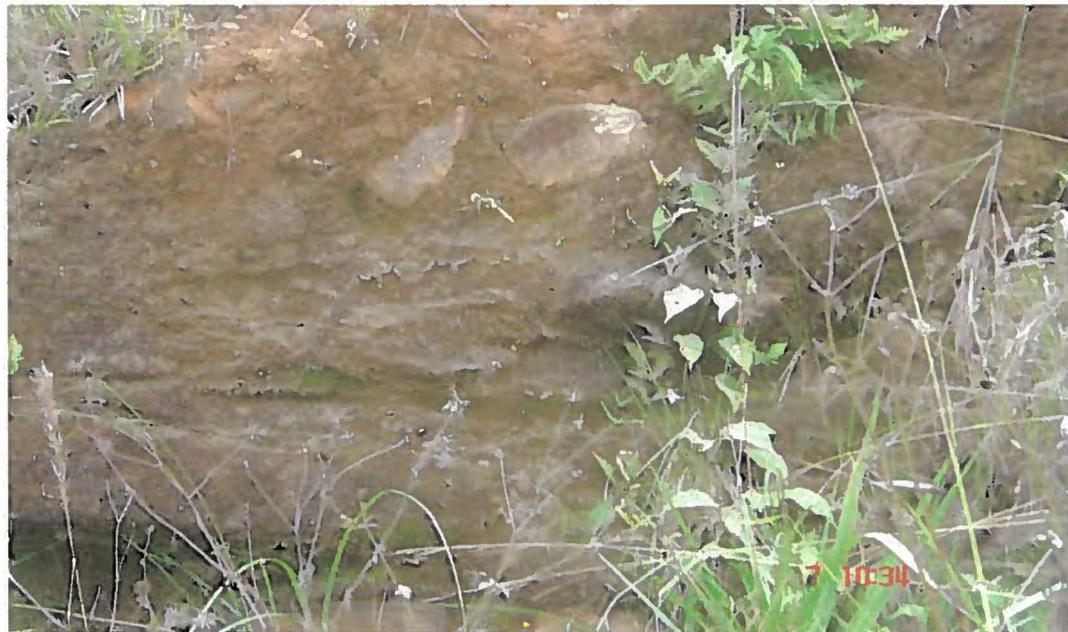
**Foto 20 –ML 17-B – Idem anterior.mostrando blocos de diabásio alterado, intercalados na massa argilosa.**
