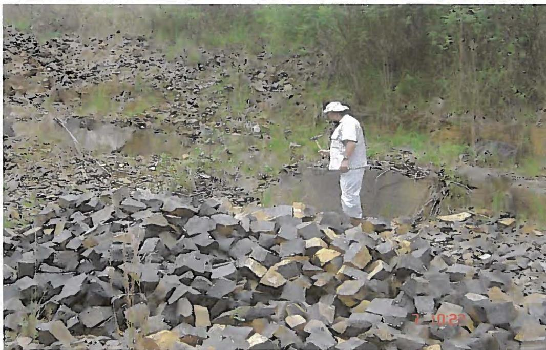
Foto 18 – ML 17-A – Faz parte do mesmo corpo ou soleira de diabásio. Pequena lavra de pedras irregulares para calçamento. No topo, pode-se conseguir algum material alterado para cascalhamento de estradas secundárias.
