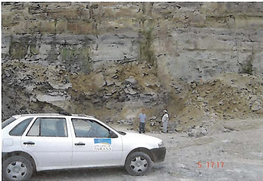
Foto 06 – Pedreira da PM de Mallet – Siltito duro, muito duro e resistente, utilizado para recobrimento de estradas secundárias, após britagem. a 3/4 Poderá ser substituído por novas pedreiras descobertas após este trabalho.
