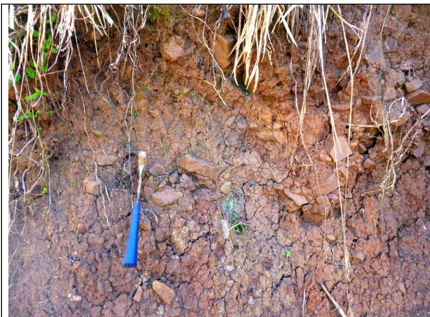
Imagem 13 – Detalhe do Neossolo Regolítico, mostrando o aspecto de desagregação do material, muito suscetível a movimentos de massa em declividades acima de 20%. Ponto MF-055.
