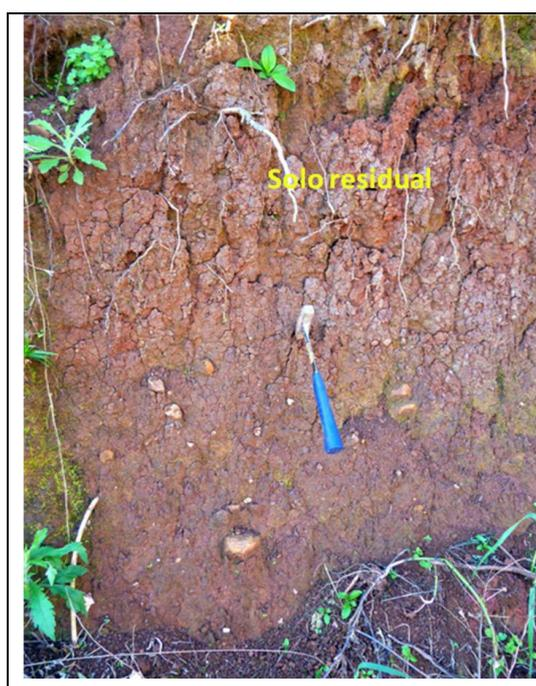
Imagem 14 – Solos residuais – Nitossolos. Ponto MF-030.
