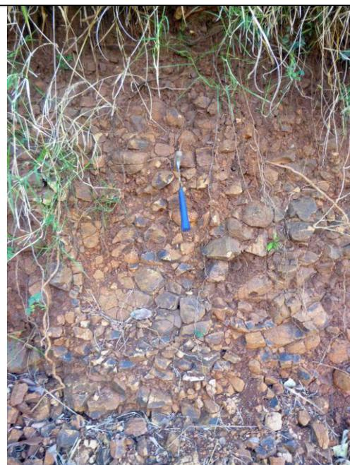
Imagens 4 – Padrões muito recorrentes da alteração da rocha basáltica na região, produzindo materiais muito inconsolidados. Esquerda - Ponto MF-013; Direita - Ponto MF-006.
