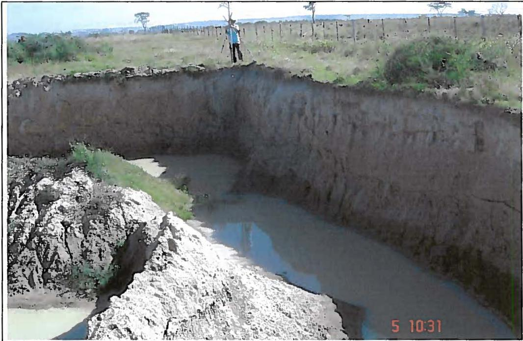
Foto-13 – Cava 12. Vide a espessura de argila existente com 4,00 metros . Observa-se alta produtividade,, chegando a 40.000 m<sup>3</sup> por hectare.
