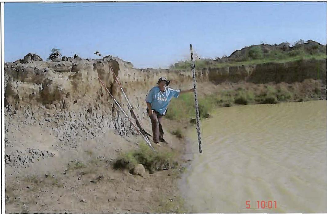
Foto-09 – Cava 11 – Tomada de profundidade, porção sul. Exposição do pacote argiloso.
