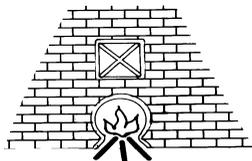
O passo seguinte é a queima dos produtos. Os fornos variam em tamanho e no modo como é aproveitado o calor. Em um forno do tipo Abóboda, por exemplo, leva-se cerca de cinco dias entre enfiar as peças, queimá-las e desenfiá-las depois de esfriadas. Em um forno Túnel, o processo leva 36 horas.
