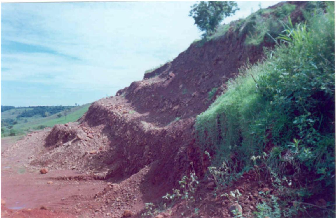
**Foto 6** Basalto alterado, fonte de saibro utilizado na conservação de estrada.
